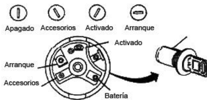
Figura 12. Posiciones del interruptor de encendido.
