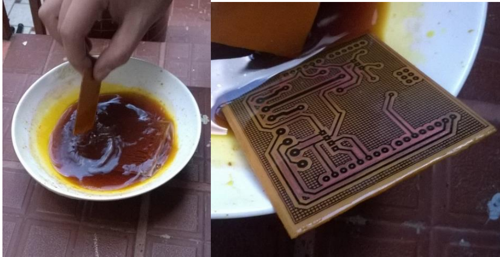
Figura 48. Placa quemada con ácido.
