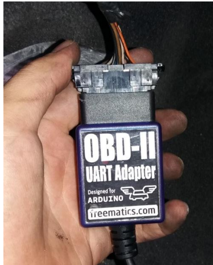
Figura 61. Conexión del Adaptador OBD-II Arduino al socket del vehículo.
