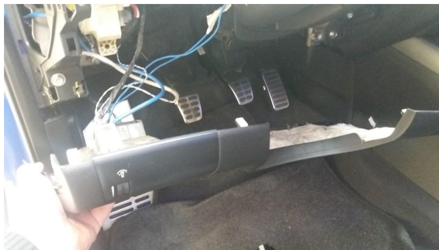
Figura 56. Desmontaje de cubierta plástica.
