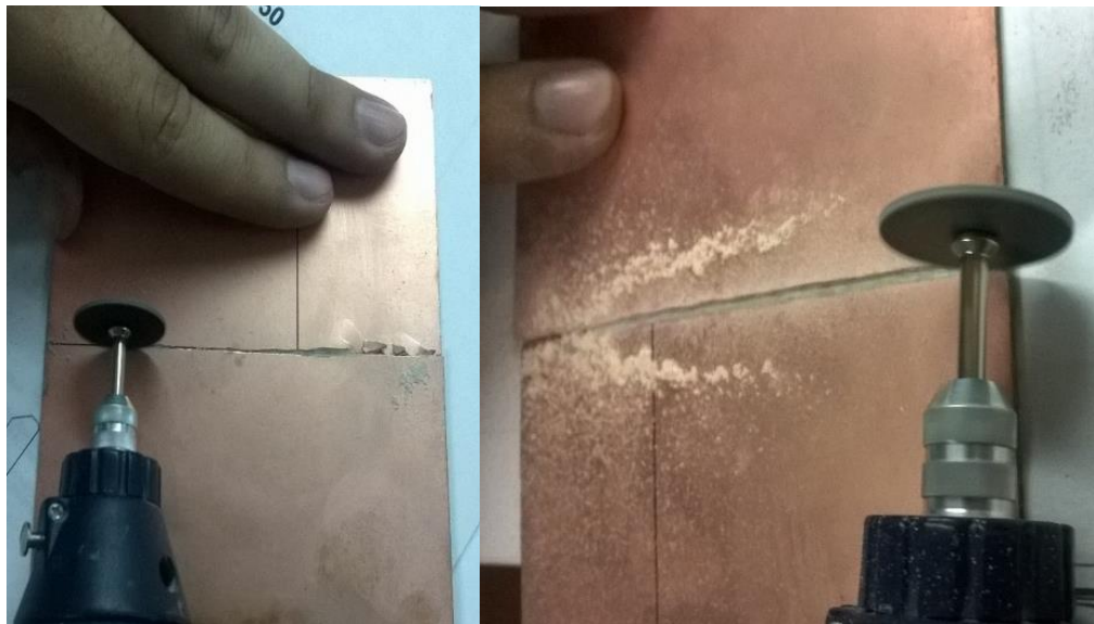
Figura 43. Trazo y corte de la baquelita.
