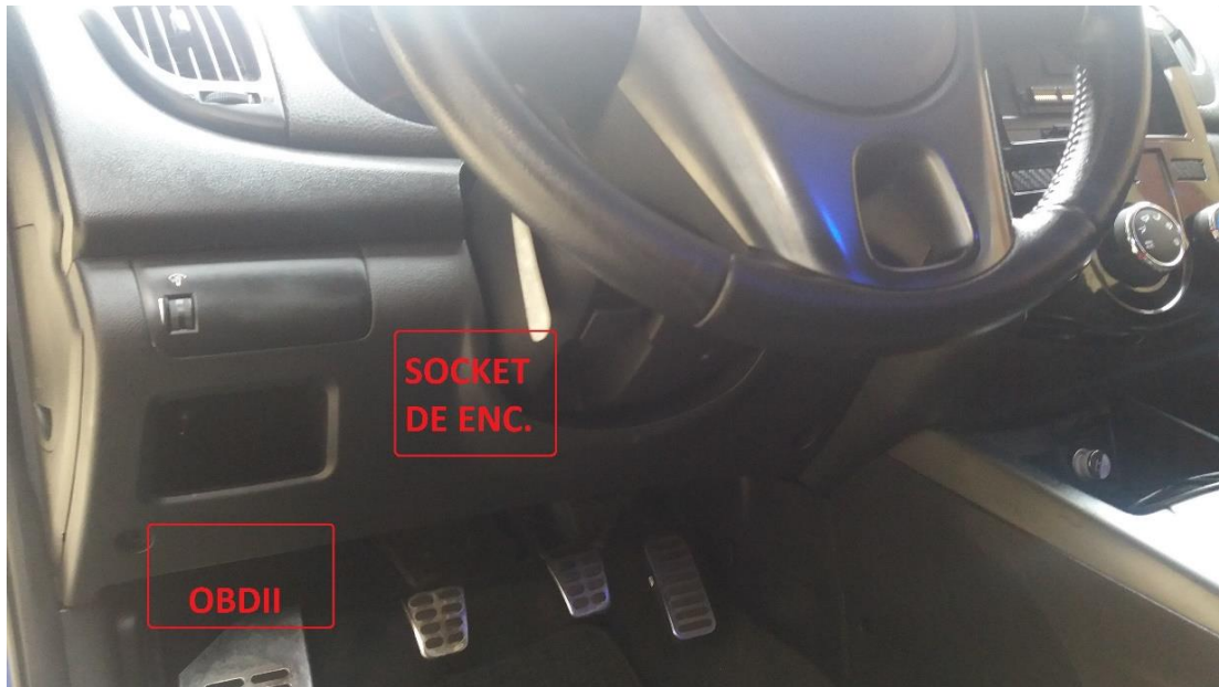
Figura 55. Posición de conector OBD-II y socket de encendido.
