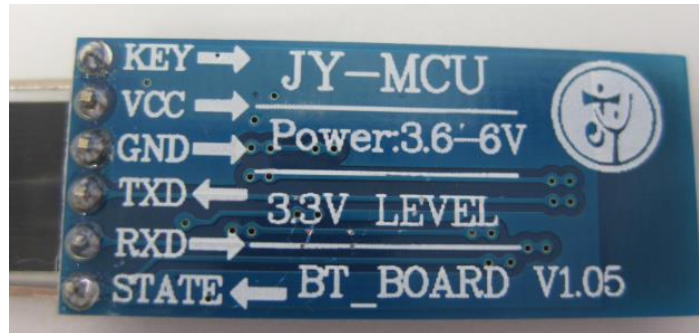
Figura 9. Pines de conexión modulo bluetooth HC05 y HC06. (Mcuoneclipse, 2015)
