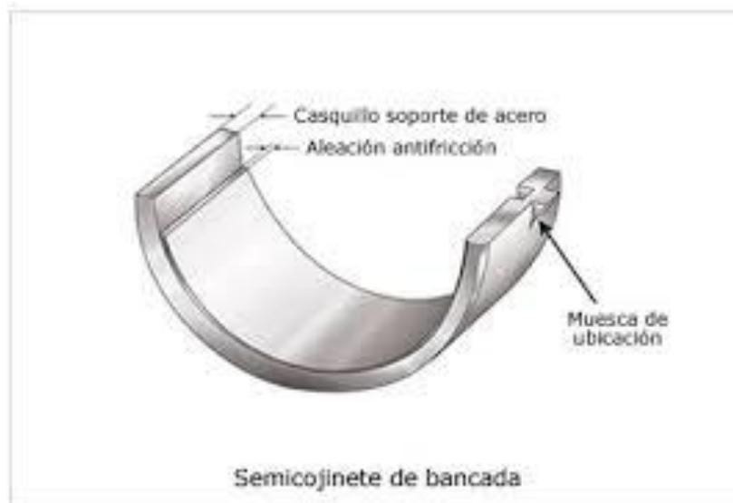
**Figura 8.** Cojinete de Deslizamiento
