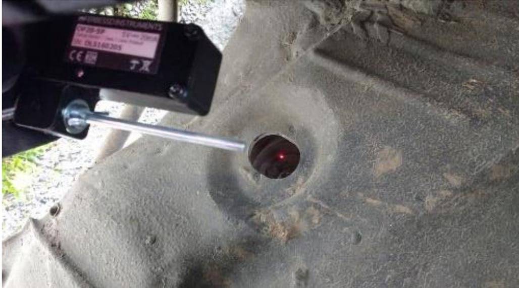
**Figura 58.** Medida en la Polea del cigüeñal
