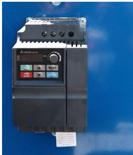
Figura 39. Variador de frecuencia
