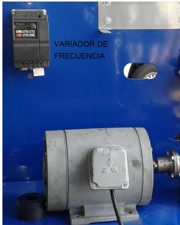
Figura 33. Variador de frecuencia
