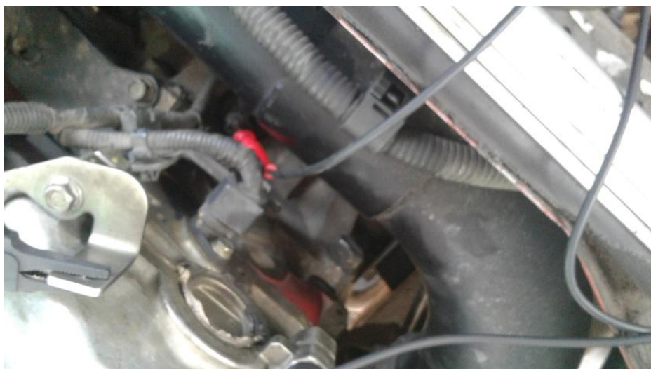
Figura 58. Grabado de señal sensor ckp HINO GH
