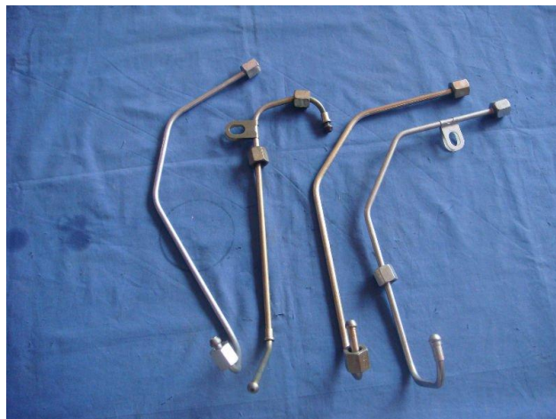
Figura 12. Cañerías de alta presión. (Bosh, 2015)
