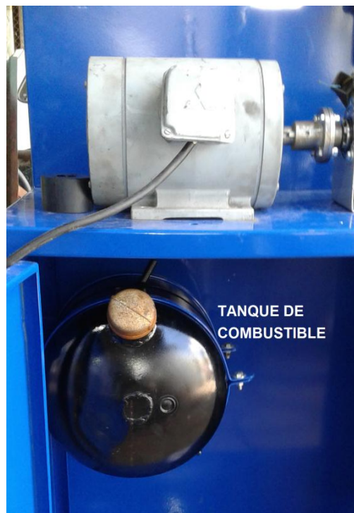
Figura 38. Tanque de combustible
