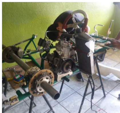
Figura 56. Apoyo del motor al tope de regulación de distancia de ejes
