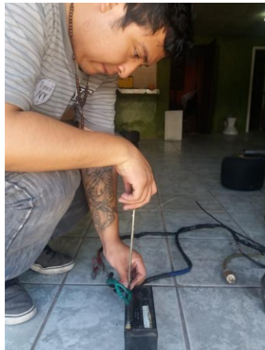
Figura 60. Fijación de bornes de batería
