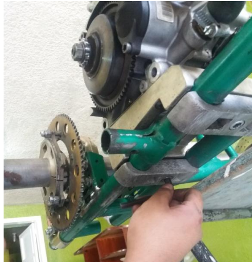
Figura 57. Ajuste de bases del motor
