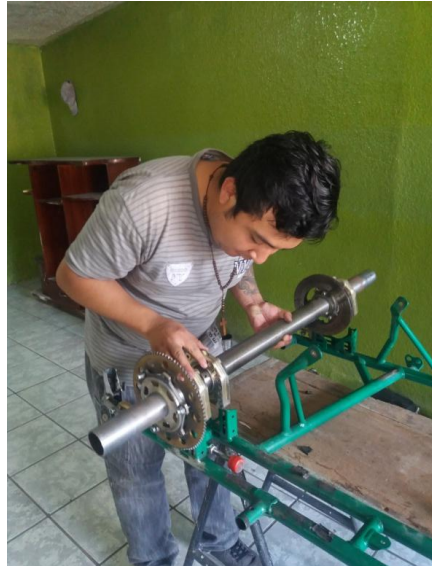
Figura 47. Montaje del eje sobre el chasis
