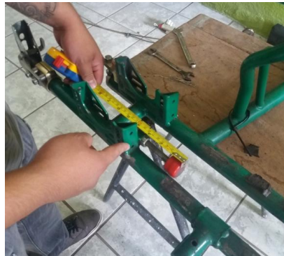
Figura 54. Calibración del tope entre motor y eje
