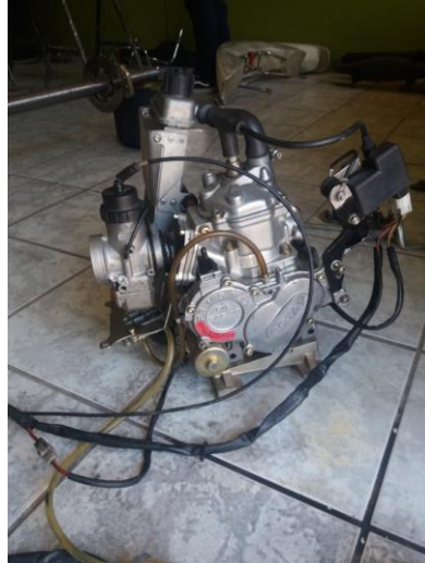
Figura 59. Conectado de arnés eléctrico al motor
