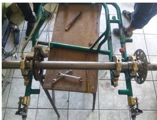
Figura 51. Sujeción del eje al chasis
