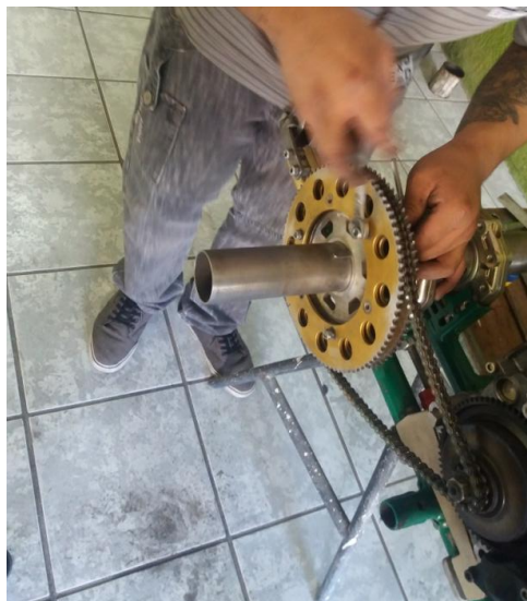
Figura 53. Ajuste de elementos de transmisión
