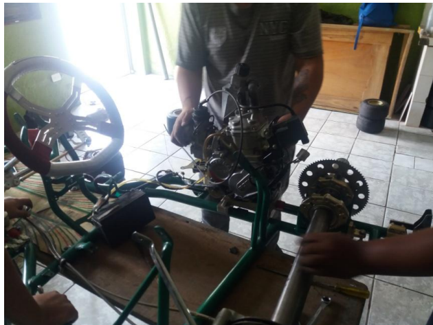
Figura 48. Montaje del motor
