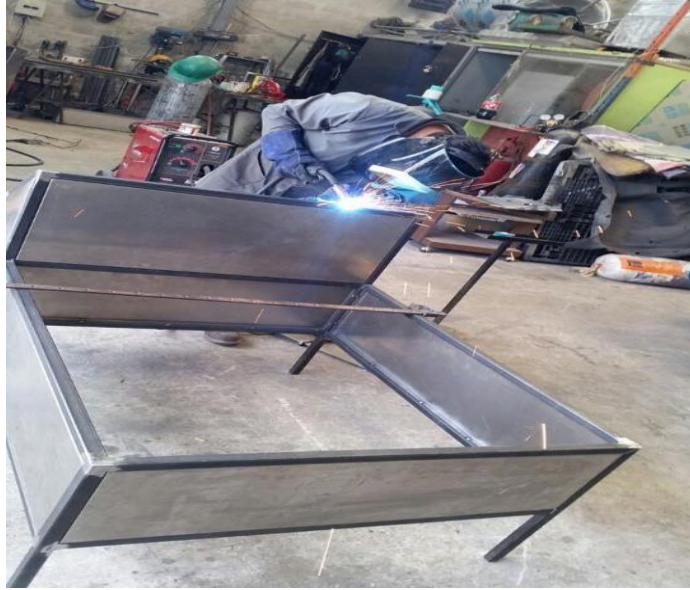
Figura. 27 Estructura metálica con láminas laterales
