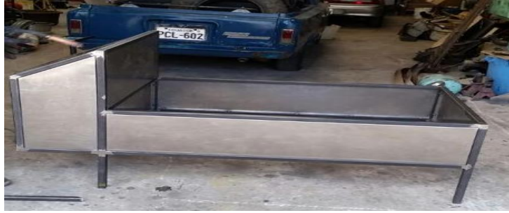
Figura. 29 Vista lateral estructura metálica con láminas laterales
