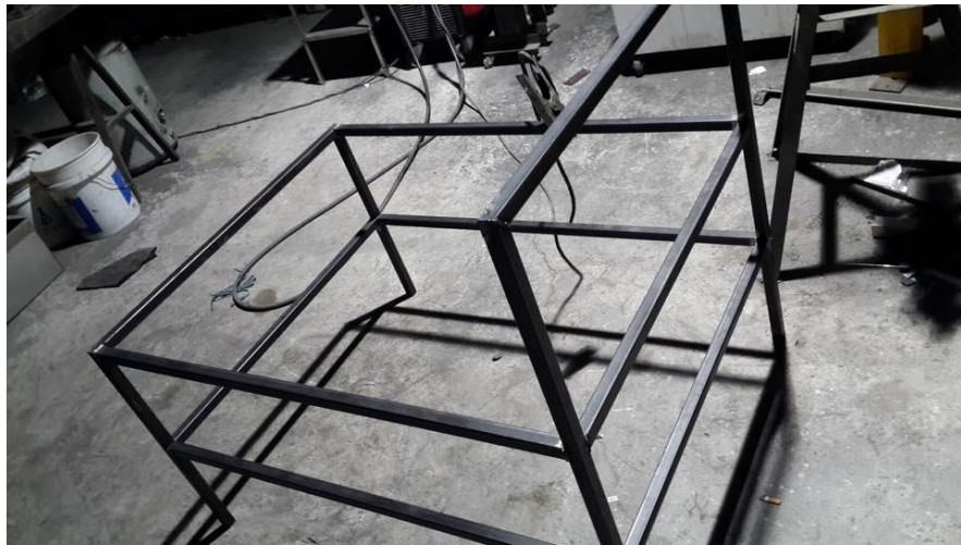
Figura. 26 Estructura metálica del banco simulador
