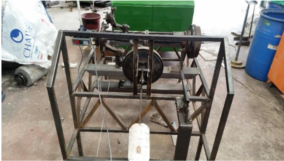
Figura 34. Montaje de pedal de freno.
