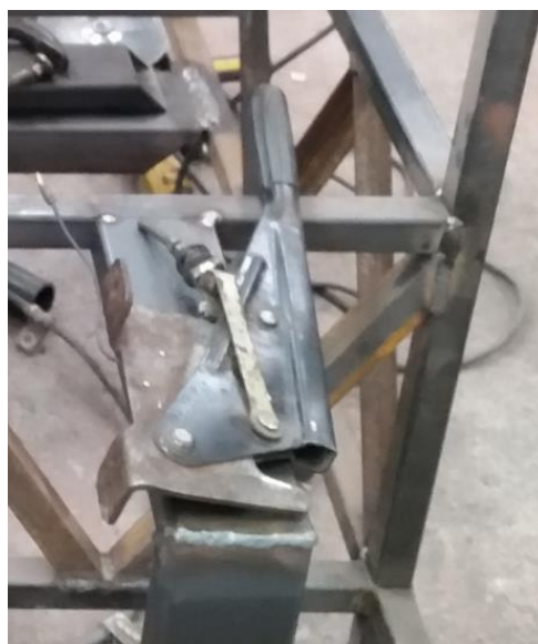
Figura 35. Montaje de freno de mano.
