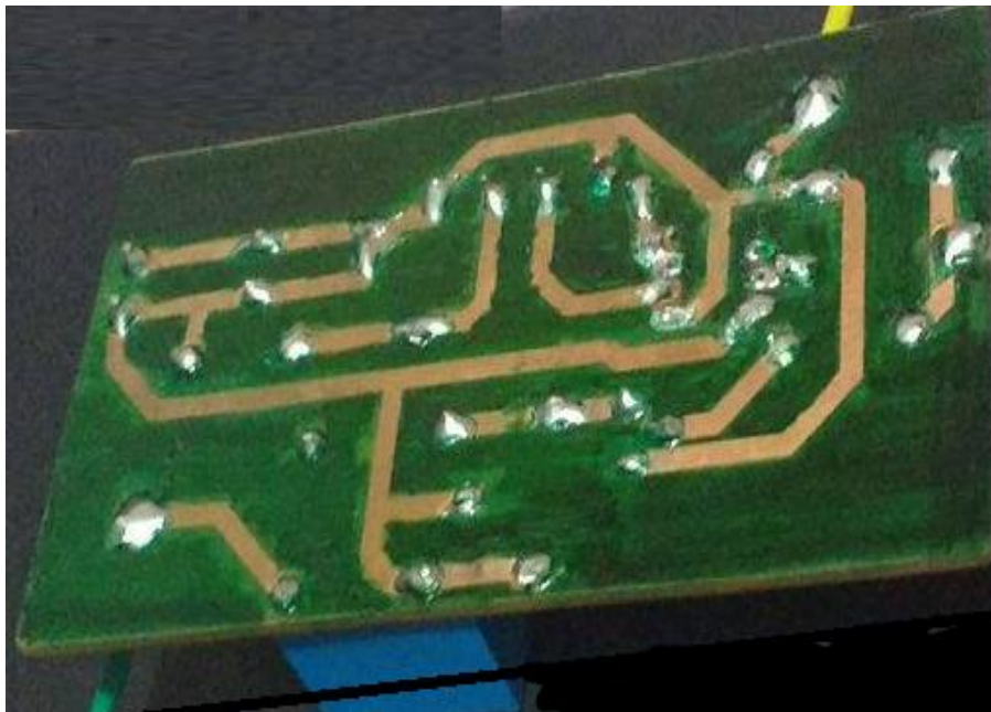
Figura 36. Suelda del circuito de control de carga
