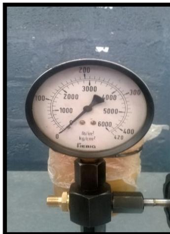
**Figura 27.** Manómetro de presión
