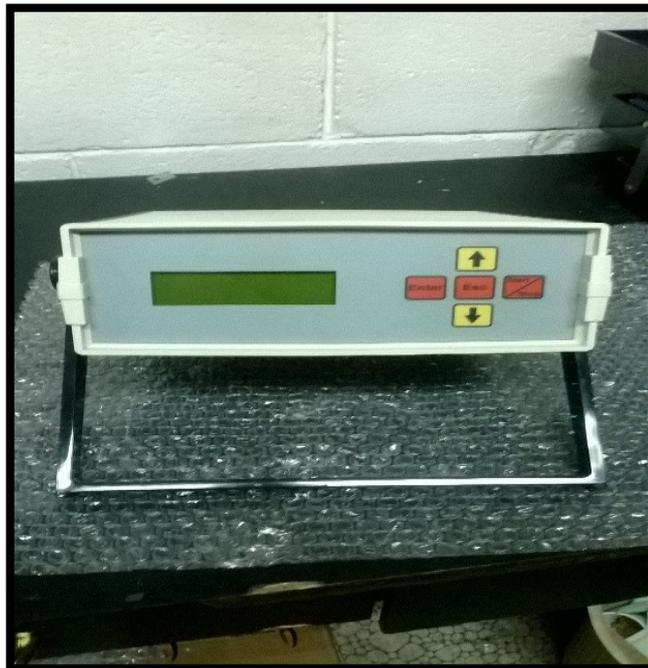
**Figura 17.** Comprobador de inyectores electrónicos
