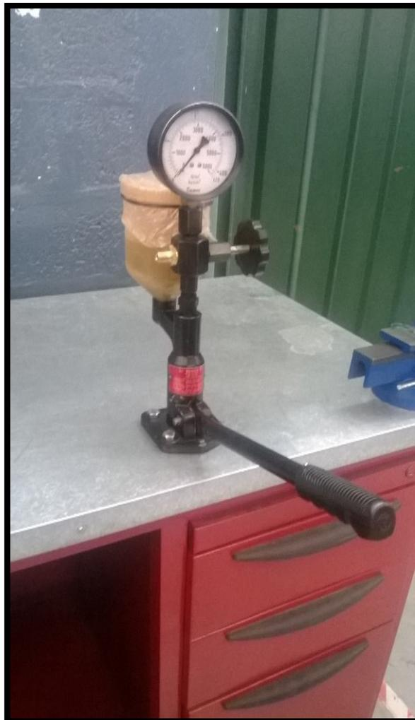
**Figura 15.** Comprobador de inyectores
