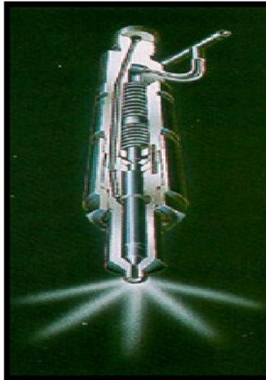
**Figura 10.** Inyector de orificios (Sánchez, 2012)
