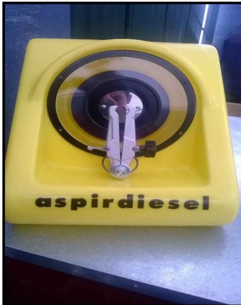
**Figura 16.** Aspirador para comprobador de inyectores Common Rail
