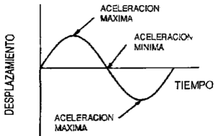
Figura 30. Gráfica de la aceleración de un objeto que vibra
