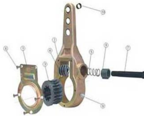
Figura 17. Despiece tensor de ajuste (BENDIX manual de frenos de aire, 2008)
