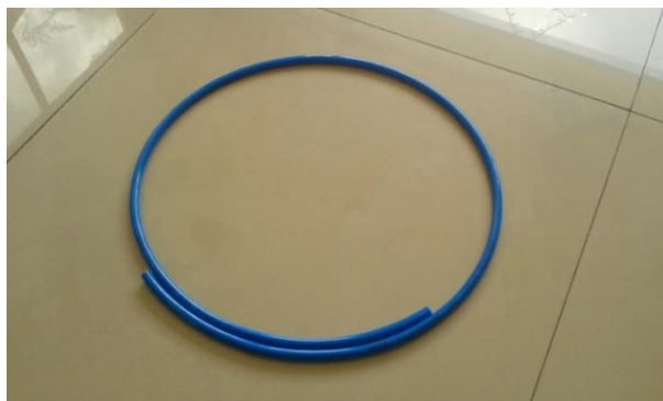
Figura 4.33. Tuberías sistema neumático.
