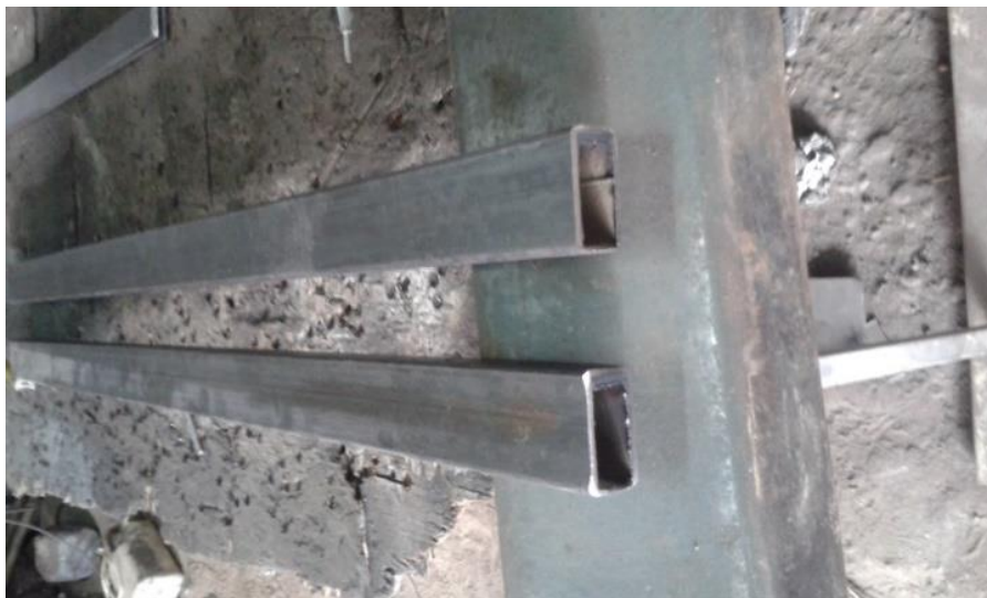
Figura 4.6. Tubo de acero rectangular.
