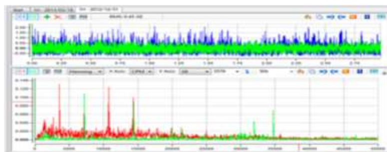
Figura 4. Señal de tiempo y FFT dual (Erbessd Instruments, 2015)
