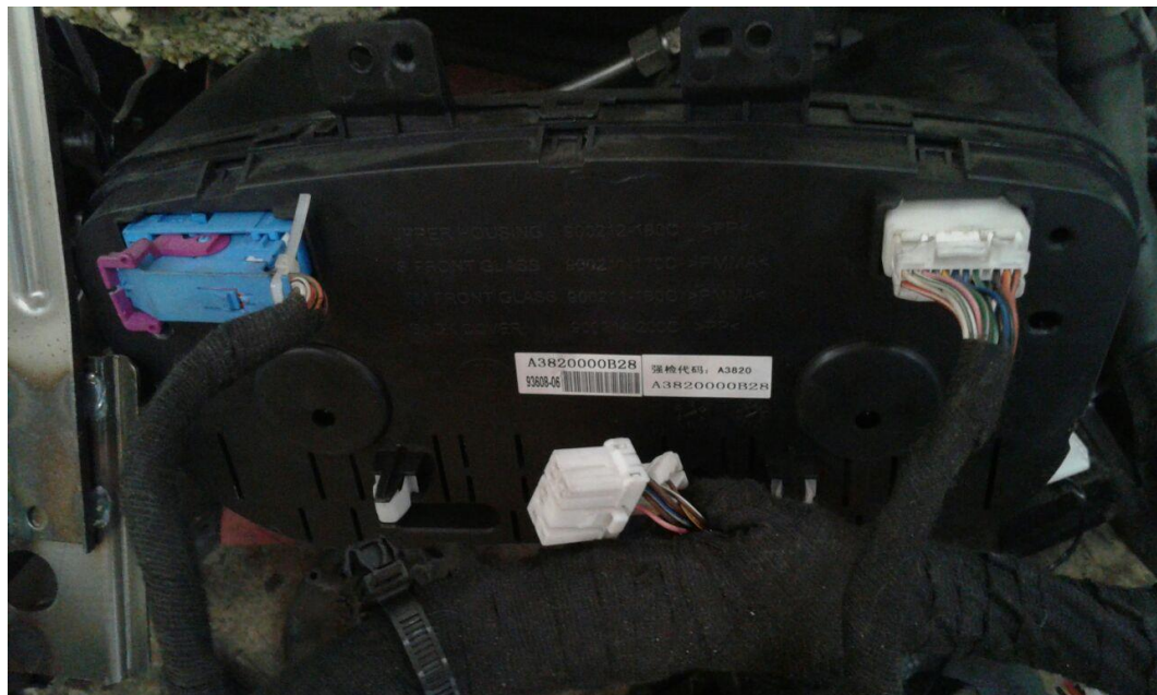
Figura 25. Fotografía sockets de tablero de Instrumentos
