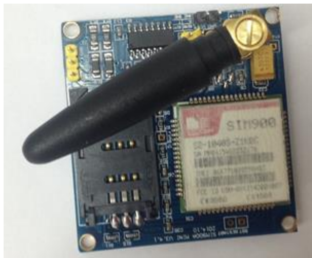
Figura 15. Fotografía módulo GSM SIM 900
