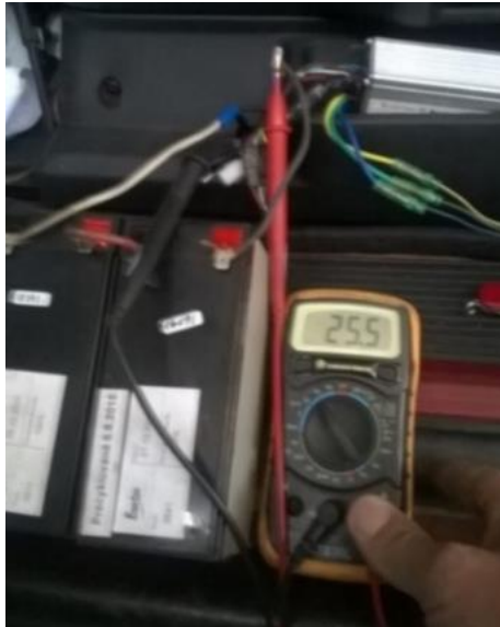
Figura 91. Voltaje obtenido con posición del pedal de freno al 90% al 95%
