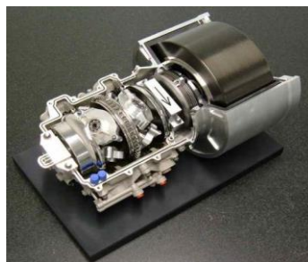
Figura 35. Freno regenerativo de cuerpo sólido o volante libre (Machine Designed, 2016)
