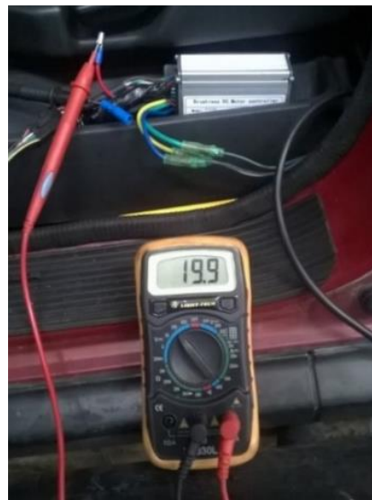
Figura 90. Voltaje obtenido con el pedal de freno al 60 % de recorrido
