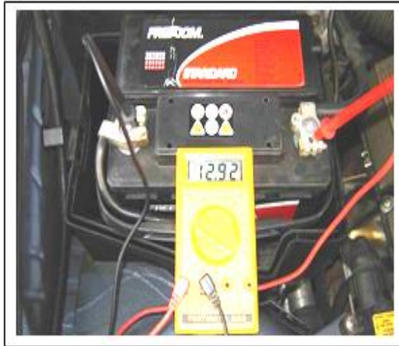
Figura 19. Comprobación del voltaje de la batería con multímetro (Posted, 2014)
