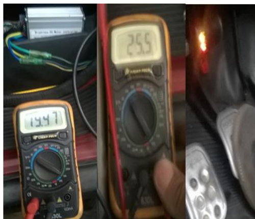
Figura 84. Medición de amperaje y voltaje entregado al sistema
