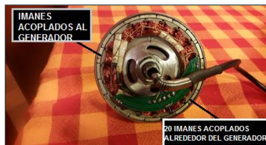
Figura 51. Disposición de imanes en el generador
