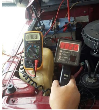
Figura 85. Medición de voltaje de la batería con el multímetro
