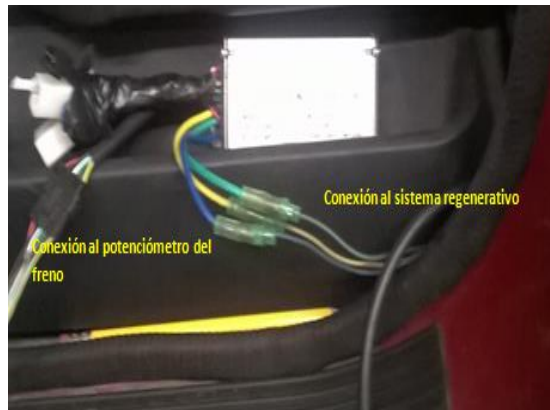
Figura 89. Conexión de elementos
