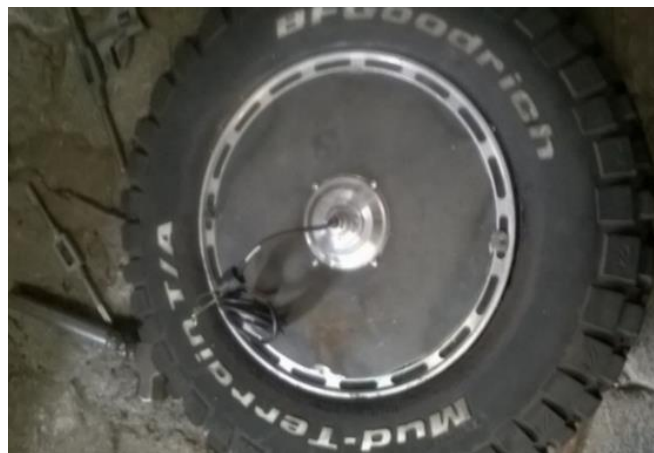
Figura 67. Montaje del disco o conjunto regenerativo al aro
