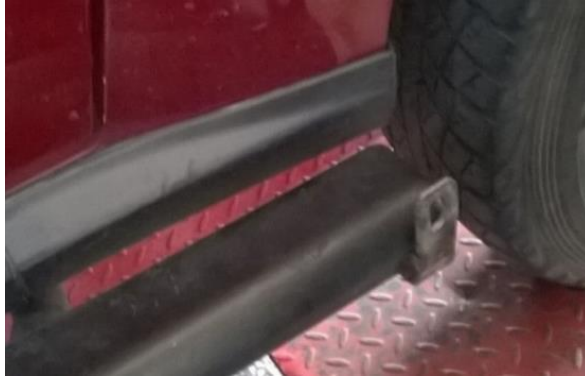
Figura 71. Elemento de unión del brazo auxiliar al chasis del vehículo
