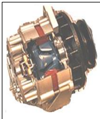
Figura 24. Alternadores de polos individuales con anillos colectores (Rodes, 2016)
