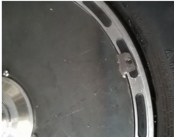
Figura 68. Fabricación de los orificios roscados en la pestaña del aro
