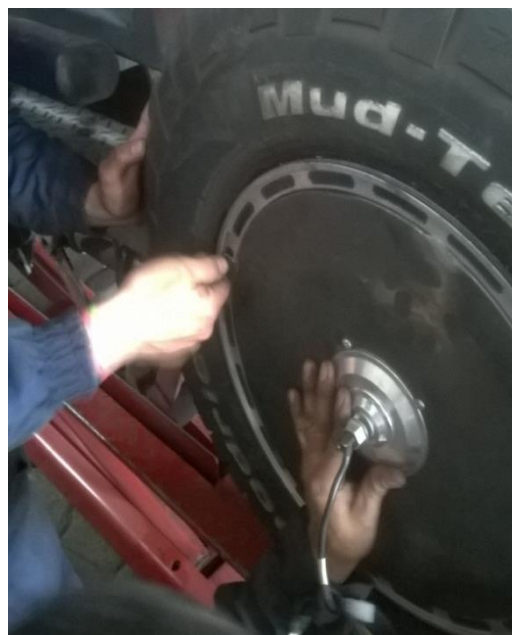
Figura 69. Montaje del sistema regenerativo en el vehículo
