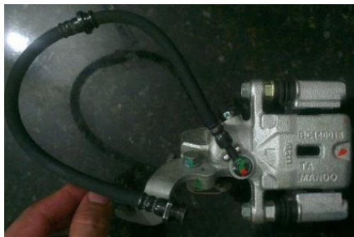
Figura 84. Verificación de fugas en la mordaza de freno
