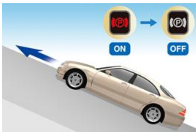
Figura 8. Sistema auto hold (FMCSA, 2016)
