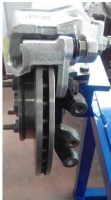
Figura 72. Fijación de la mordaza de freno
