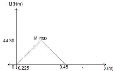
Figura 23. Diagrama de momento flector viga 1
