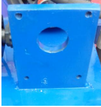
Figura 63. Placa de apoyo de la bomba hidráulica
