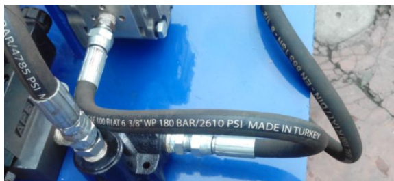
Figura 62. Selección de cañerías para alimentación y retorno
