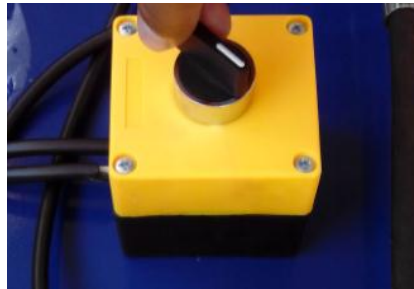
Figura 77. Arrancador del motor eléctrico
