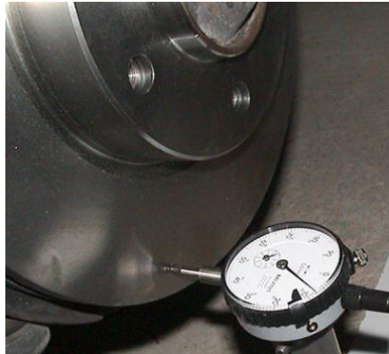
Figura 83. Prueba con reloj palpador
