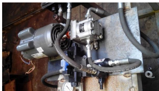
Figura 49. Base para el circuito hidráulico
