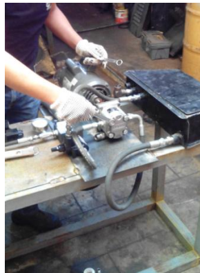
Figura 64. Ensamblaje del circuito hidráulico
