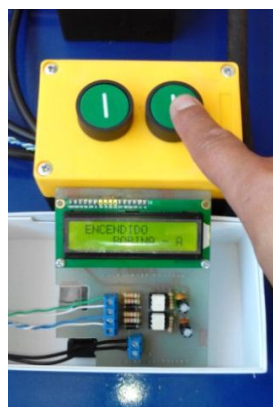
Figura 79. Encendido, activación de la bobina A
