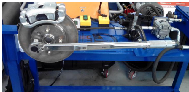
Figura 85. Verificación de frenado por medio de un torquímetro
