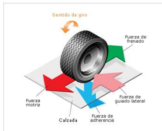
Figura 3. Fuerzas que intervienen en el neumático (Agueda, 2014)
