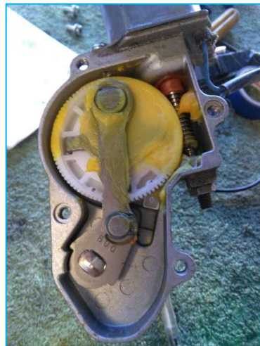
Figura 67. Configuración de motor con tornillo sin fin y corona
