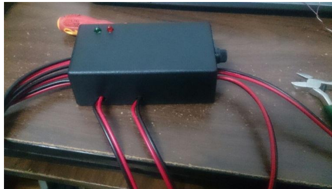
Figura 94. Protección del módulo electrónico
