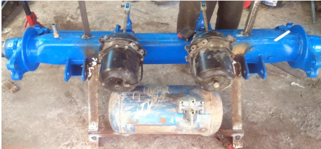
Figura 48. Ensamble de tanque sobre estructura metálica.
