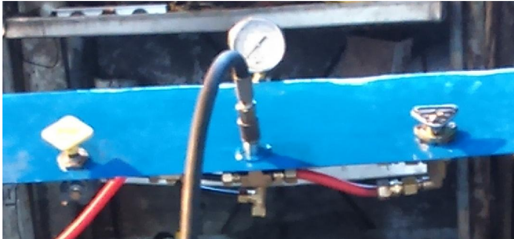
Figura 42. Suministro de aire por medio de línea externa.
