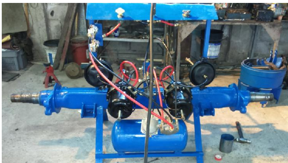
Figura 52. Colocación y acople de mangueras en banco de pruebas.
