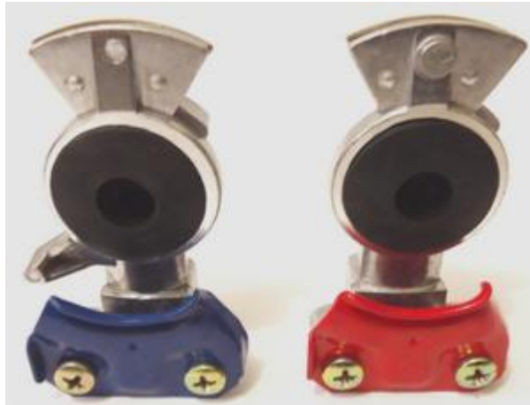
Figura 32. Conectores para líneas de aire en semirremolque.
