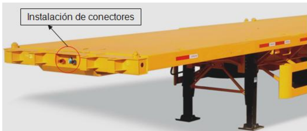
Figura 33. Fijación de conectores de líneas de aire en estructura de semirremolque.
