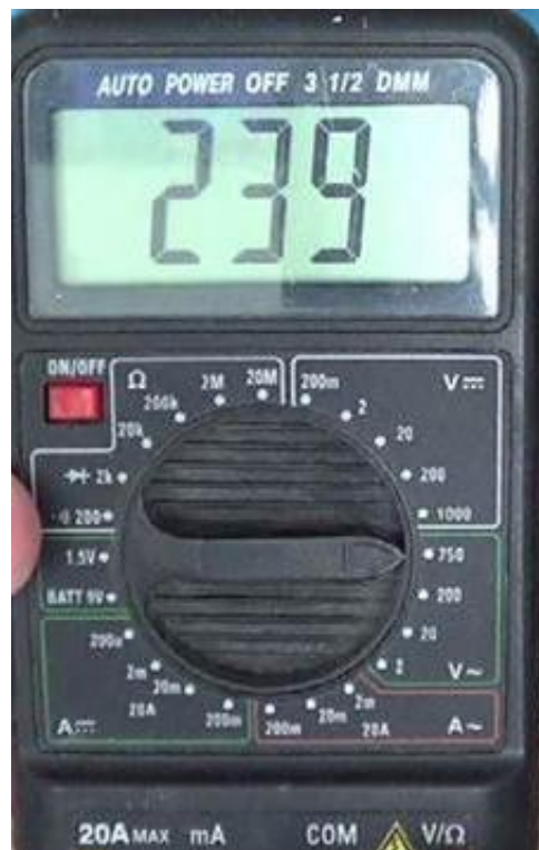
FIGURA 45. SEÑAL DEL MULTIMETRO DE 220V
