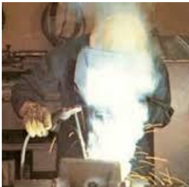
FIGURA 13. HUMOS VISIBLES AL SOLDAR (Ingeniería industrial online, 2013)
