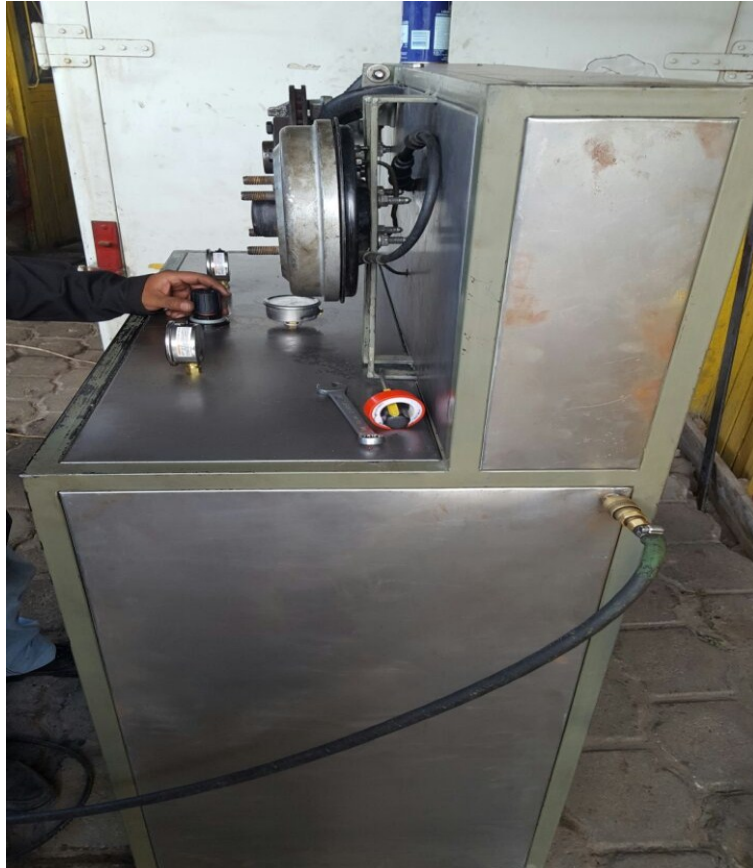
Figura 96. Regulación de la válvula de presión
