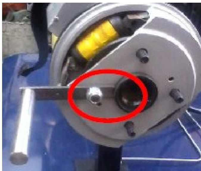
Figura 100. Sacando tuercas que sujetan al tambor
