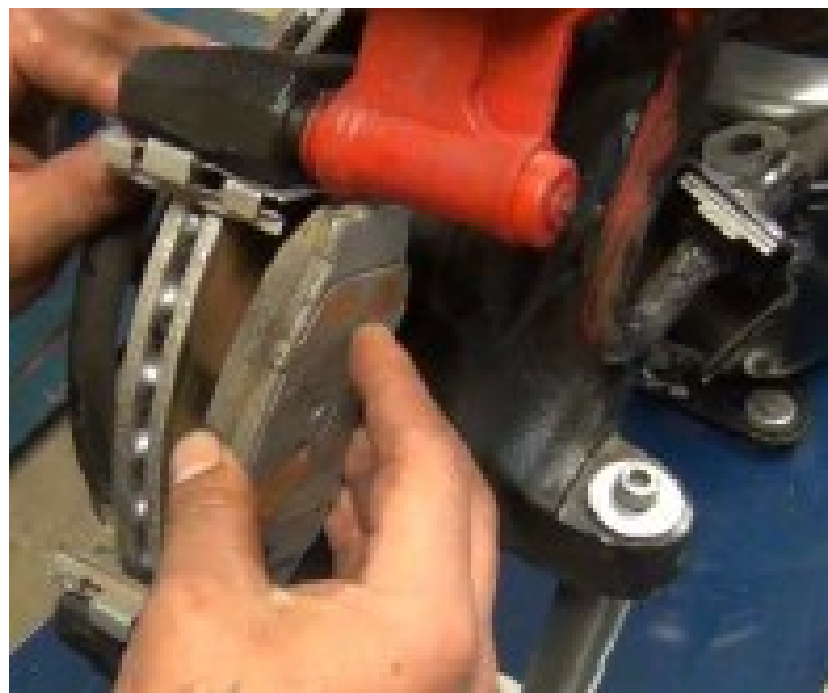
Figura 113. Instalación de las pastillas de frenado
