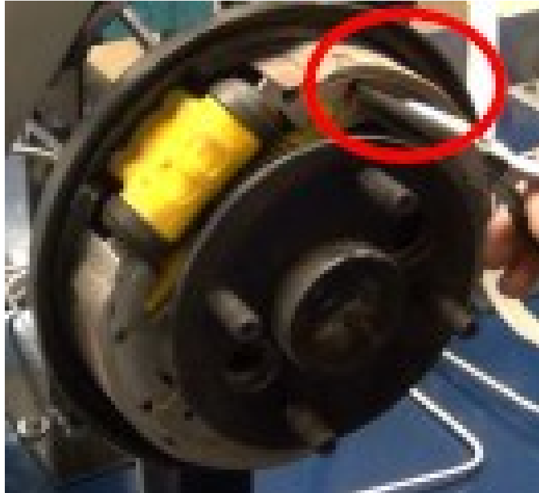
Figura 103. Extracción de muelles de recuperación de zapatas
