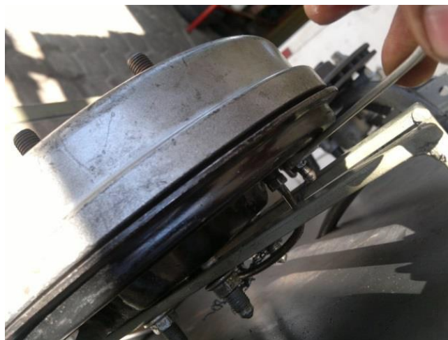
Figura 89. Válvula de purga del tambor
