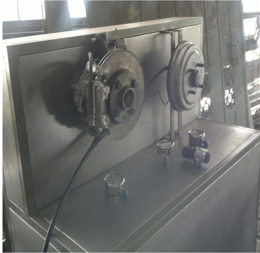
Figura 74. Estructura con su recubrimiento con disco y tambor instalados
