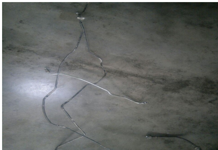
Figura 31. Foto de las cañerías del sistema de frenos
