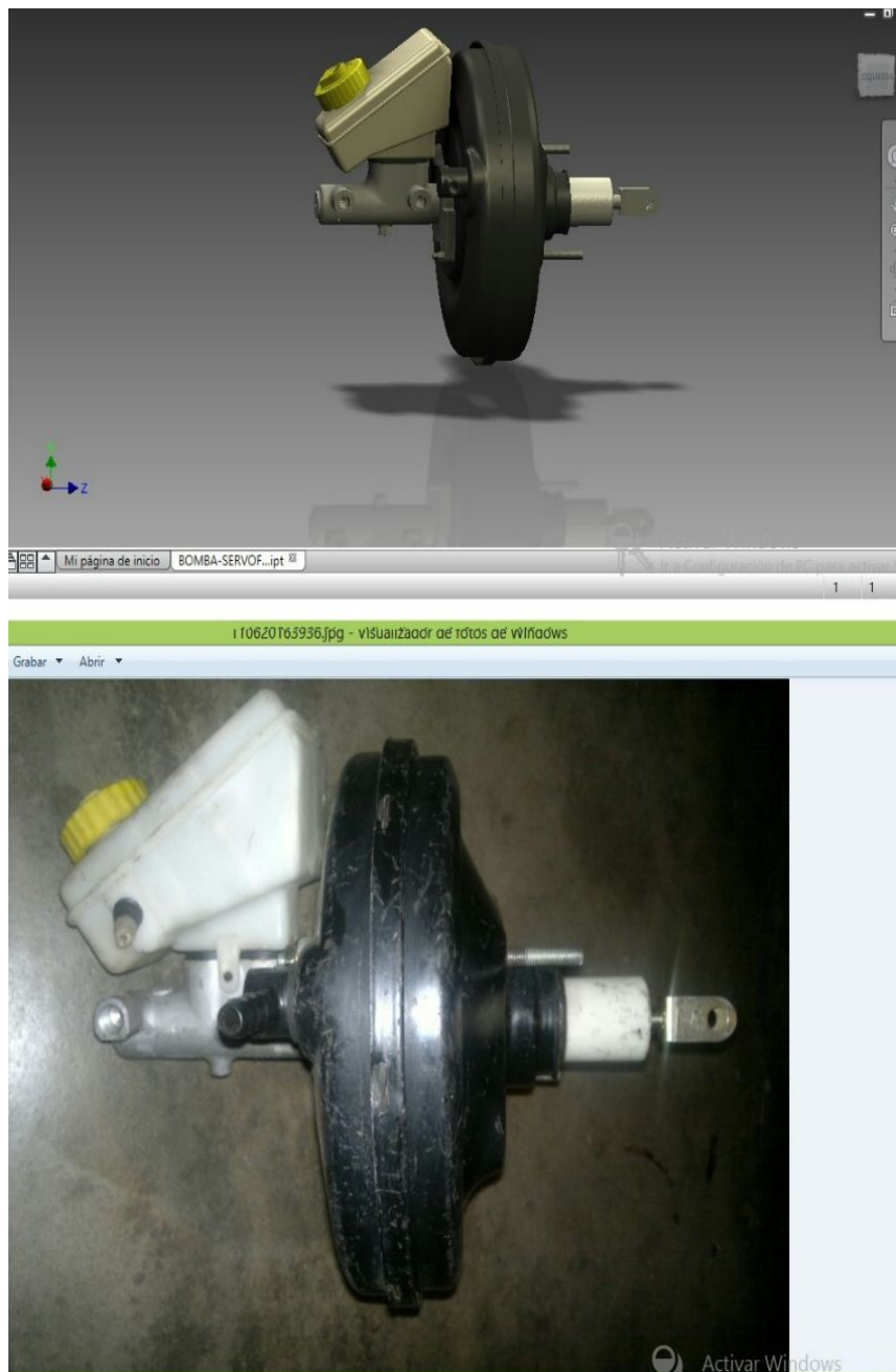
Figura 45. Diagrama mecánico en 3d y foto real de la Bomba-servofreno
