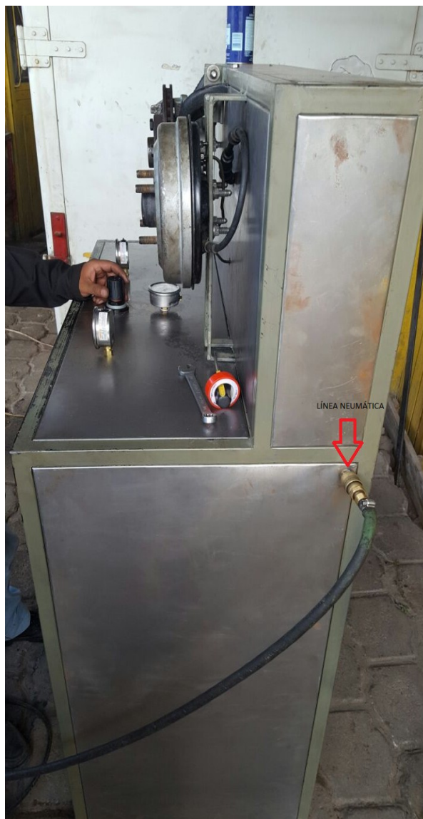
Figura 88. Conexión de aire o línea neumática conectada al banco de pruebas
