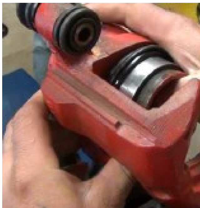
Figura 111. Instalación del pistón en su alojamiento en la mordaza
