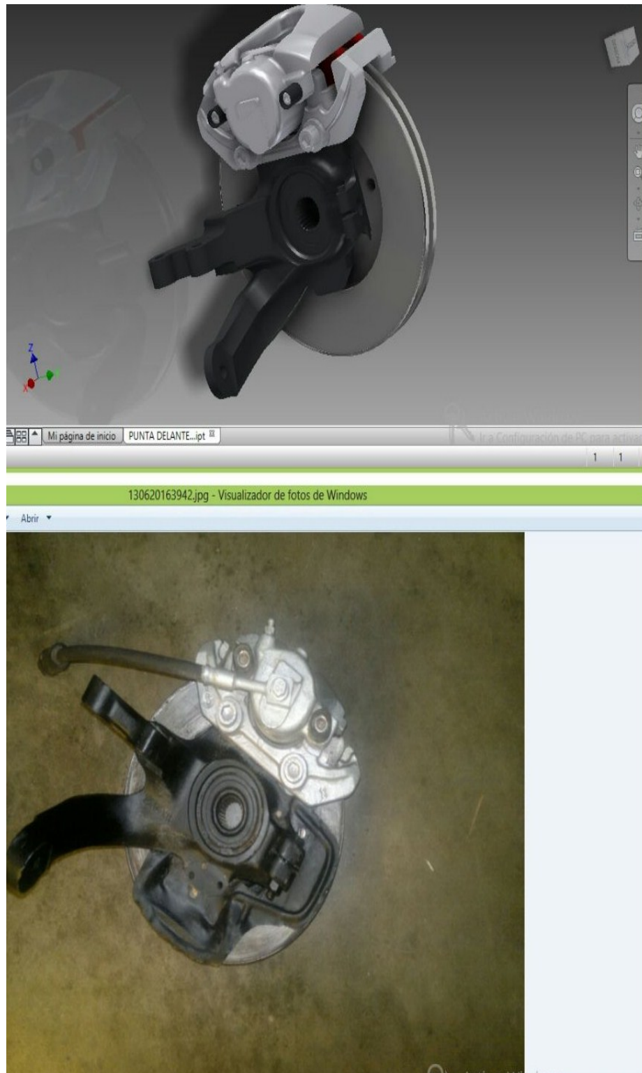
Figura 47. Foto real y diseño mecánico en 3d del disco de freno
