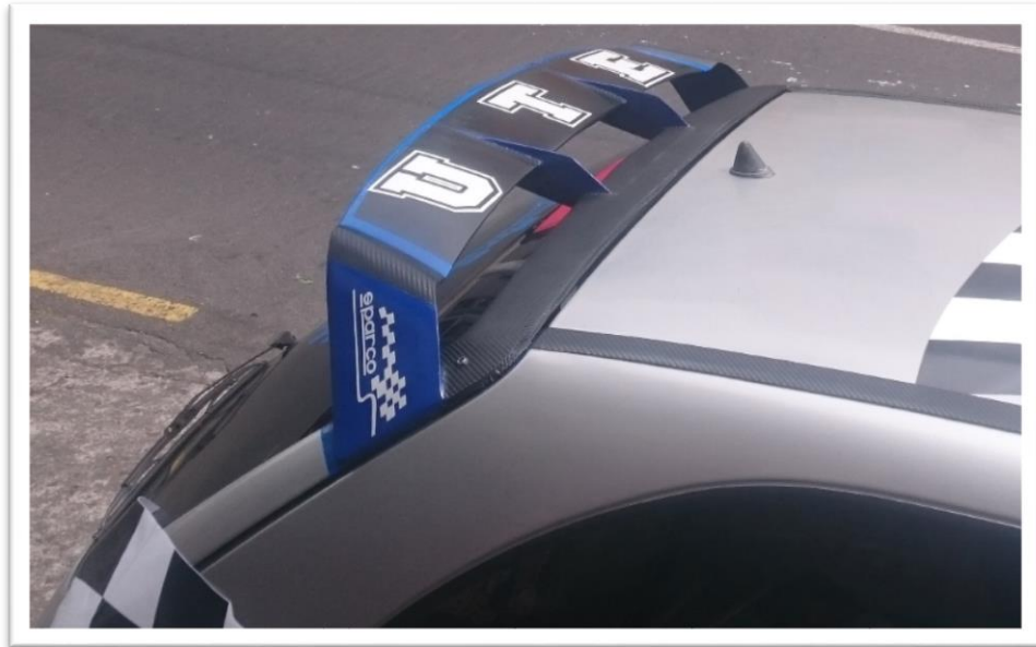
Figura 74. Alerón colocado a 6^\circ
