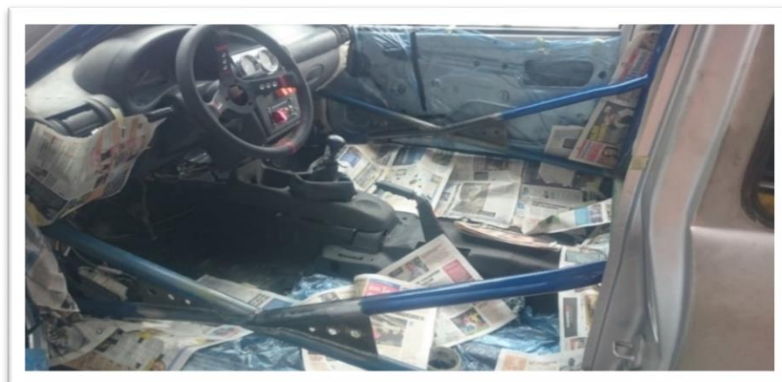
Figura 63. Soldadura de refuerzos del roll bar
