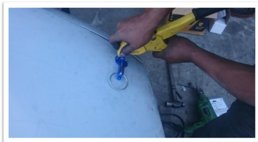
Figura 78. Remachada de seguros de capot
