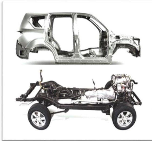
Figura 5. Carrocería Con Chasis Independiente (Mechanic, 2015)
