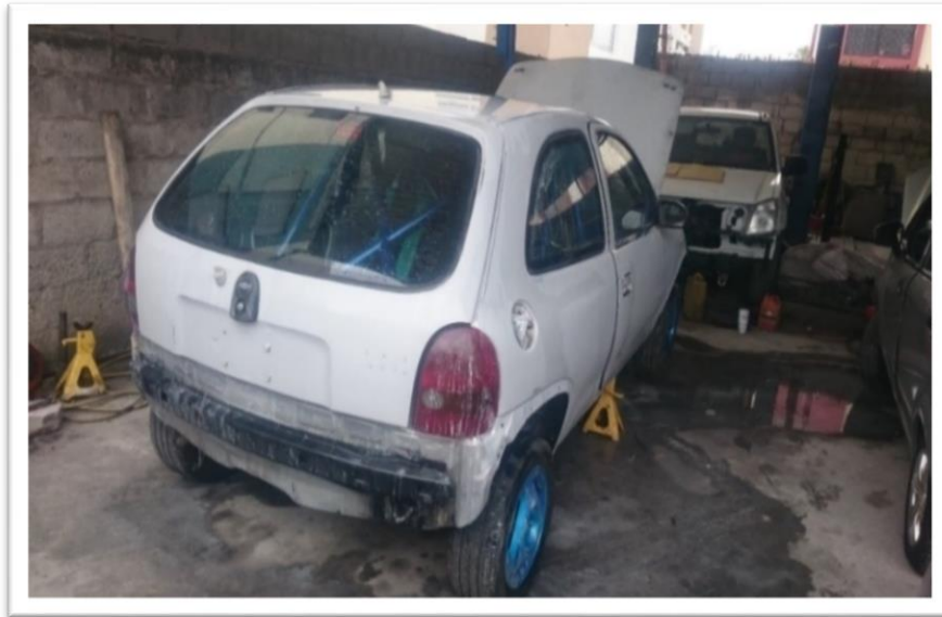
Figura 79. Limpieza del vehículo para el proceso de fondeo
