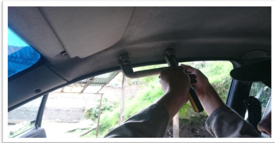
Figura 38. Remoción del techo
