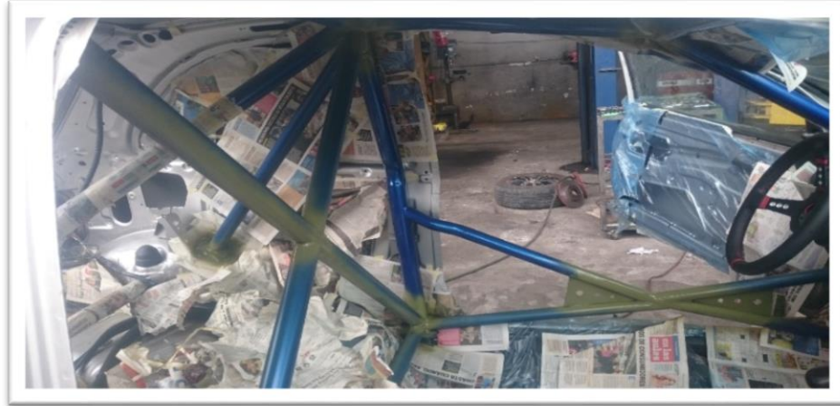
Figura 64. Preparado del Roll Bar para la pintura final
