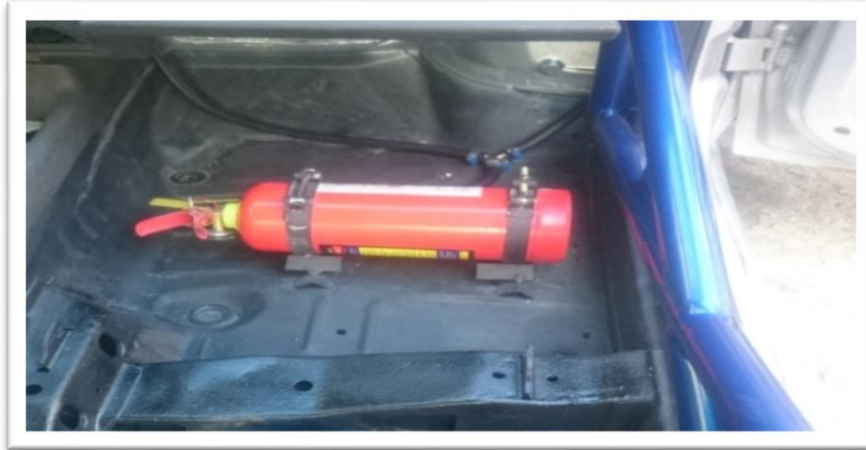
Figura 68. Instalación del extintor
