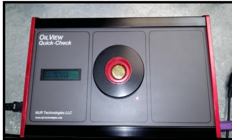
Figura 19. Comprobación de la limpieza del sensor
