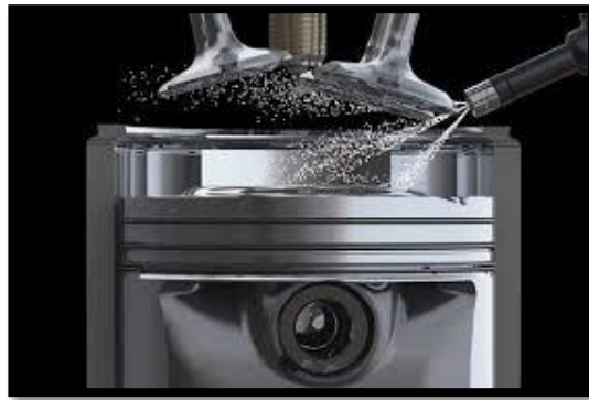
Figura 4. Atomización del inyector (Widman, International SRL, 2015)
