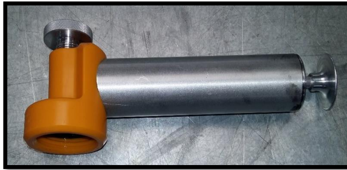
Figura 14. Bomba de vacío para recolección de muestras de aceite (Lubream, 2014)
