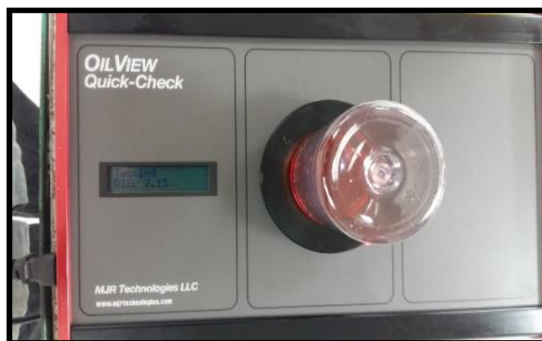
Figura 22. Medición de la constante dieléctrica de aceite de referencia
