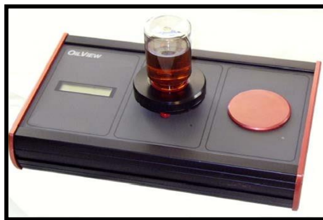
Figura 5. Equipo oilview quick check para análisis rápido de aceite (Manual OilView Quick-Check, 2010)
