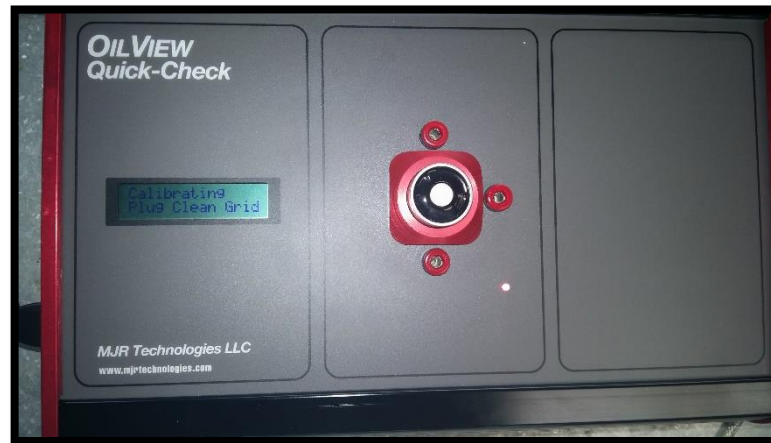
Figura 21. Proceso de calibración con el fluido 300
