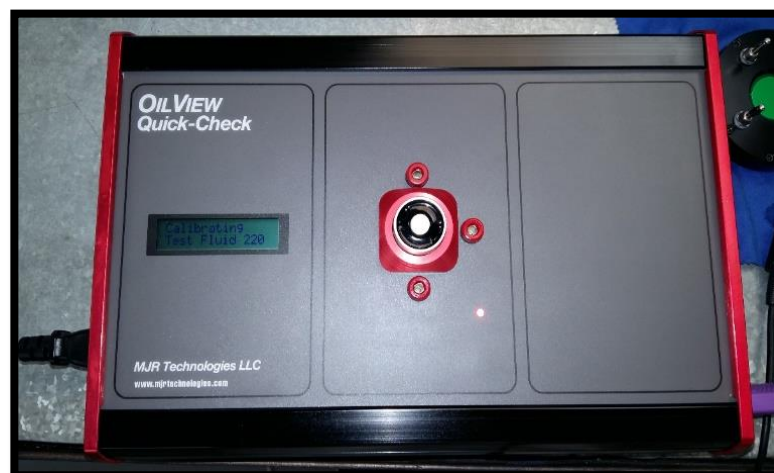
Figura 20. Calibración con el fluido 220
