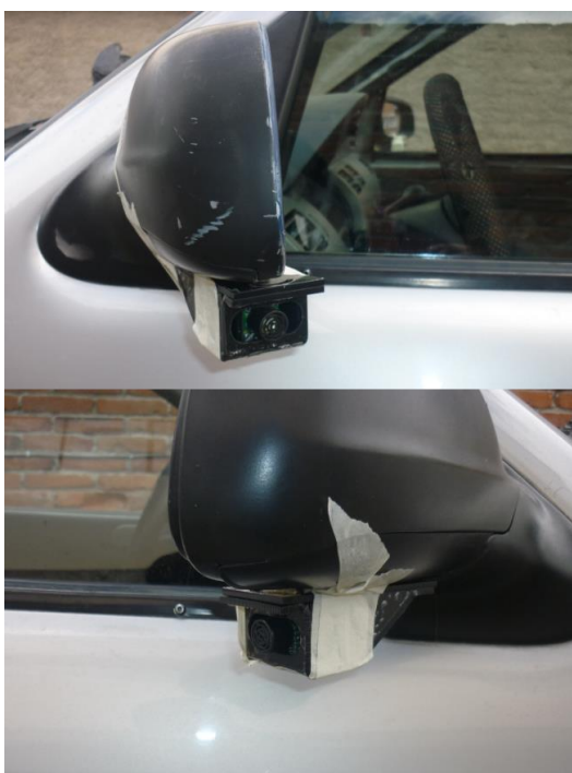
Figura 106. Ubicación de los sensores en la prueba 2
