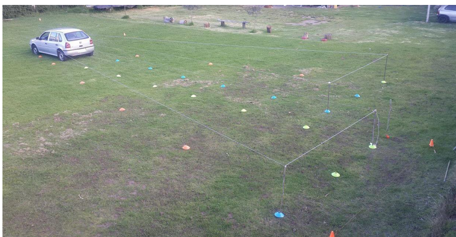
Figura 61. Zona visible por los espejos retrovisores marcada con platos y cuerda (vista 2)
