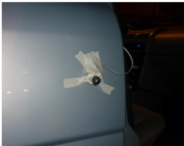
Figura 102. Ubicación sensores de ultrasonido prueba 1
