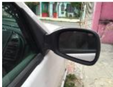
Figura 14. Espejo retrovisor exterior derecho (Practicatest.com, 2016)
