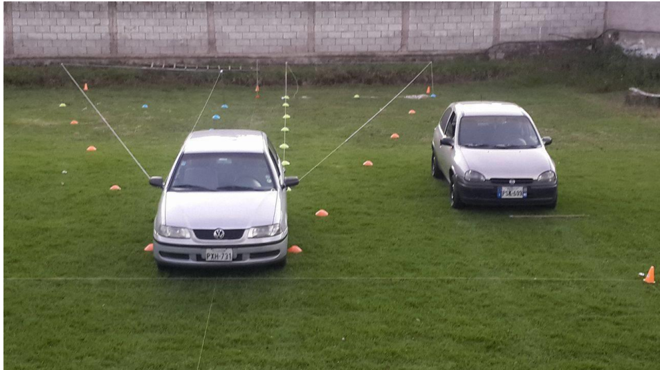
Figura 68. Vehículo Corsa Wind ubicado en la zona de punto ciego izquierdo del automóvil (vista 1)
