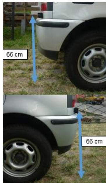
Figura 109. Altura de los sensores prueba 3
