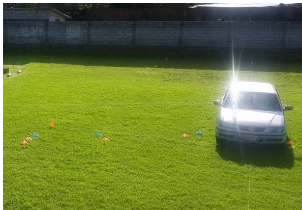
Figura 53. Zona ciega del pilar A der. Marcado con cuerda y platos
