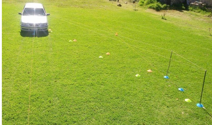
Figura 50. Zona ciega del pilar A izq. Marcado con cuerda y platos
