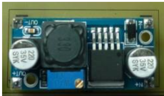
Figura 81. Regulador de voltaje
