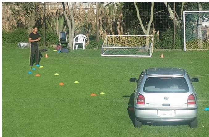
Figura 51. Medición del área ciega
