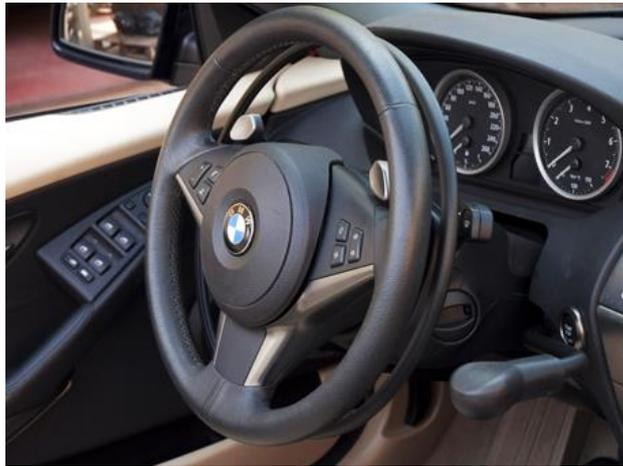
**Figura 11.** Aro de aceleración bajo volante (IBILKOM, 2016)
