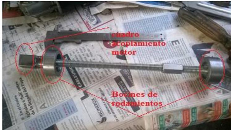
**Figura 41.** Acoplamiento eje roscado y bocines con cuadro en un extremo
