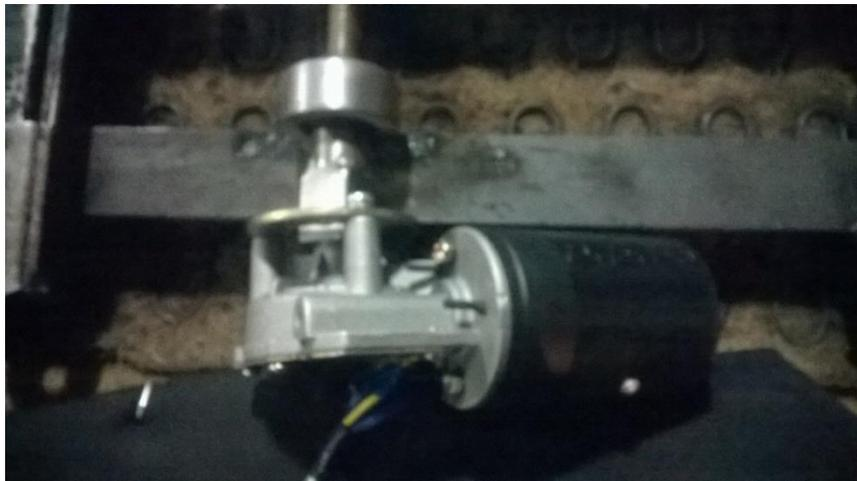
**Figura 51.** Acople finalizado de motor con el sistema de entrada y salida del asiento.
