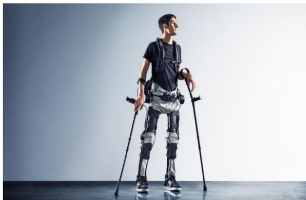
**Figura 8.** Exoesqueleto Eléctrico Phoenix (SUITX, 2016)
