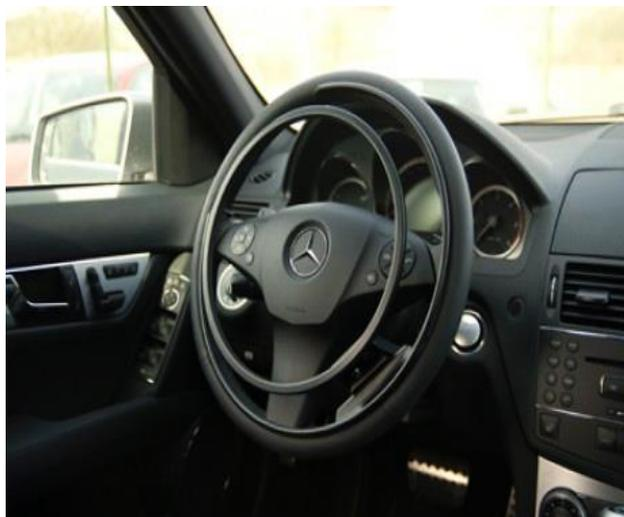
**Figura 10.** Aro de aceleración y palanca de freno (IBILKOM, 2016)
