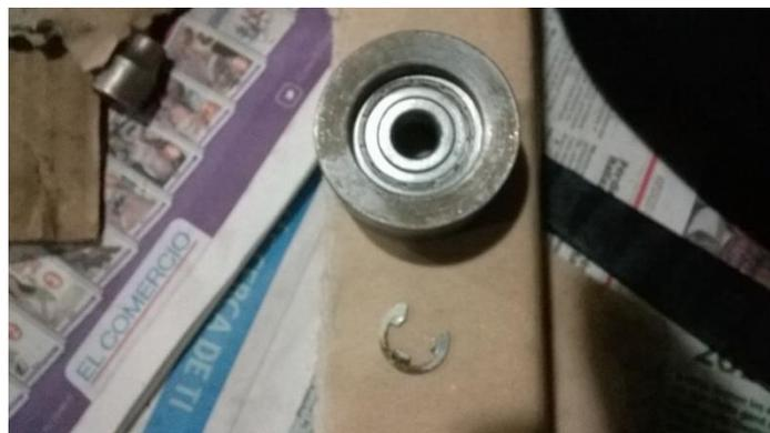
**Figura 40.** Arandela de presión y rodamiento de 5 mm
