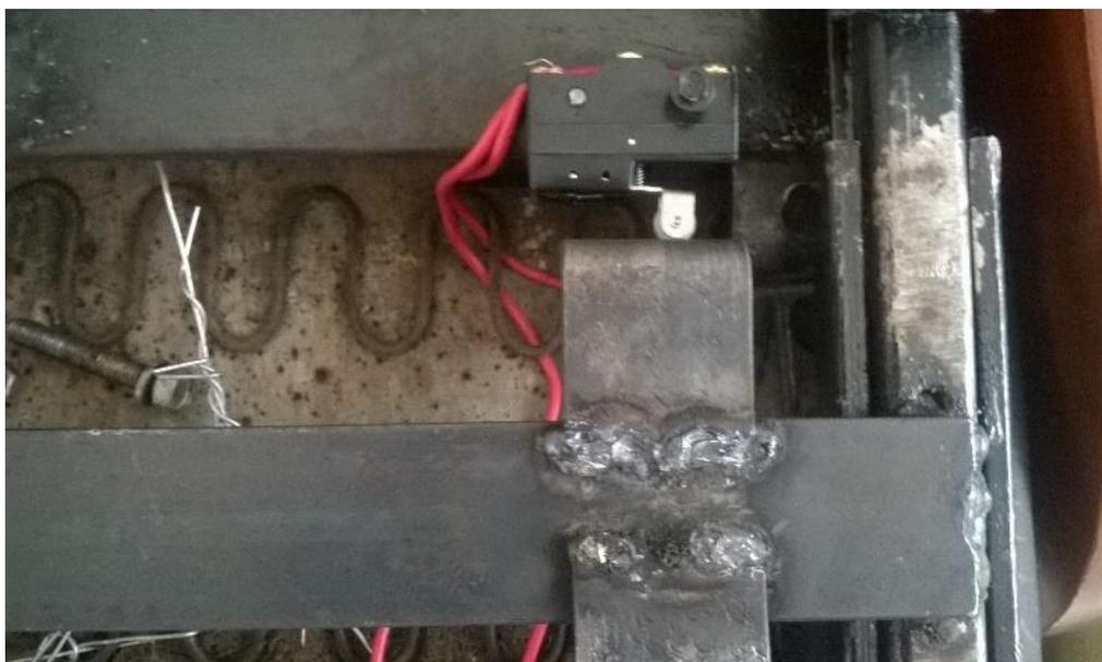
**Figura 55.** Activación controlador de fin de carrera salida del asiento
