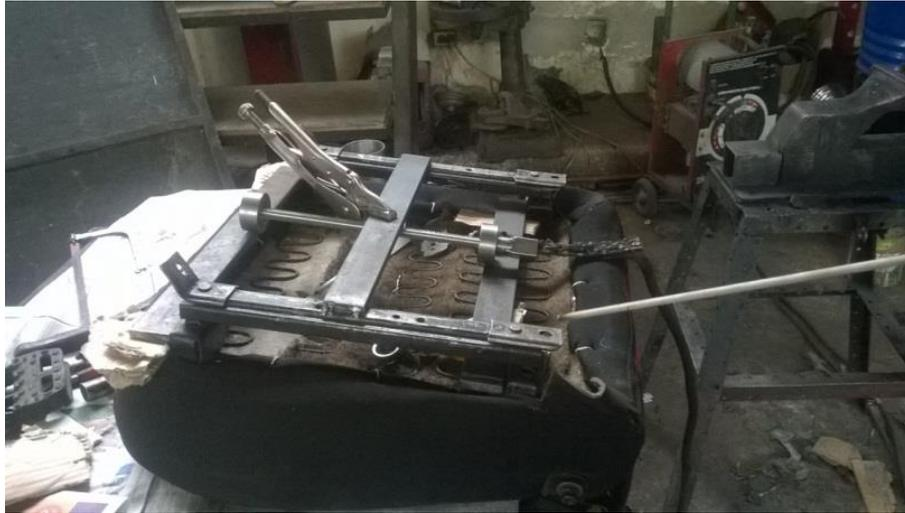
**Figura 47.** Soldadura del tornillo sin fin, eje de transmisión de movimiento
