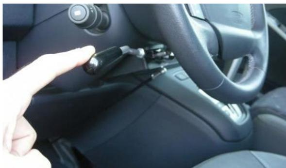
**Figura 12.** Acelerador y freno de leva (TECNUM, 2009).
