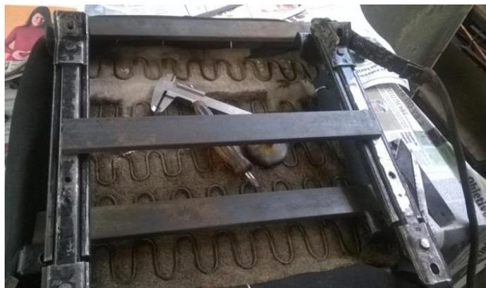
**Figura 44.** Acople tres placas en rieles desmontados
