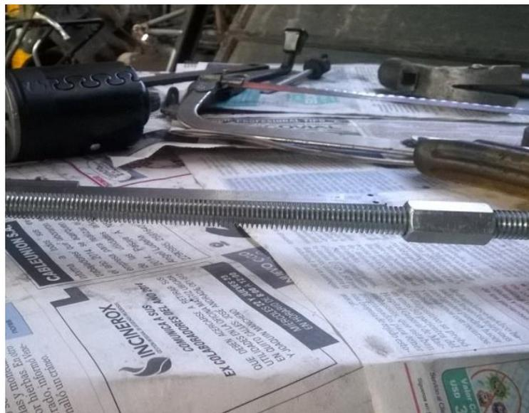
**Figura 38.** Tornillo sin fin utilizado
