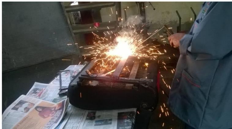
**Figura 46.** Soldadura placas en rieles
