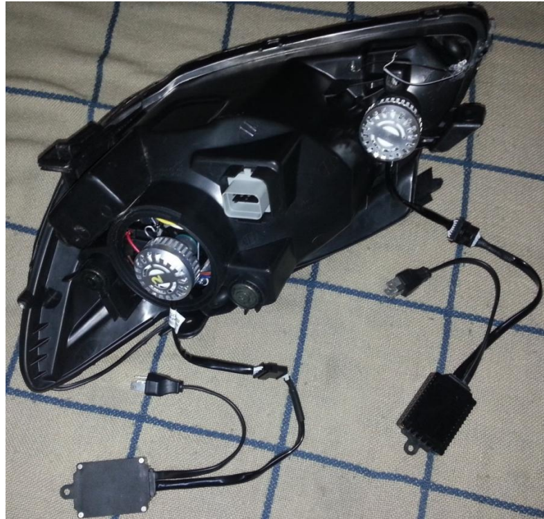
Figura 79. Resultado final de la adaptación de la lámpara.
