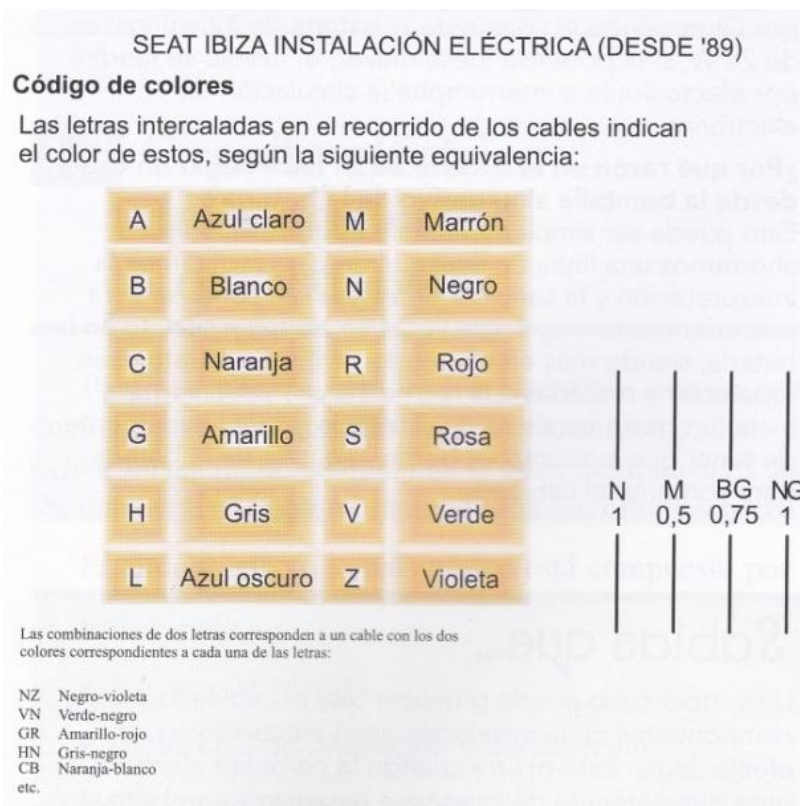
Figura 15. Código de color de cableado SEAT. (ROS MARÍN & BARRERA DOBLADO, 2011)
