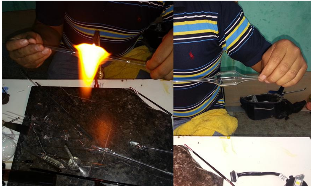
Figura 75. Fabricación de cápsulas de vidrio soplado.
