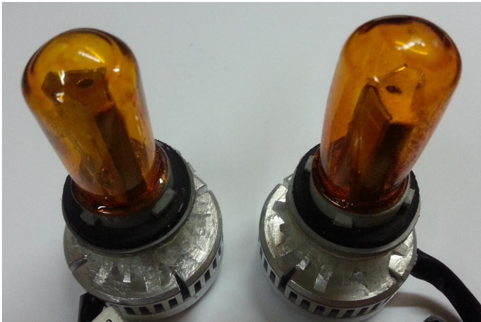
Figura 77. Modificación de color de las bombillas led.
