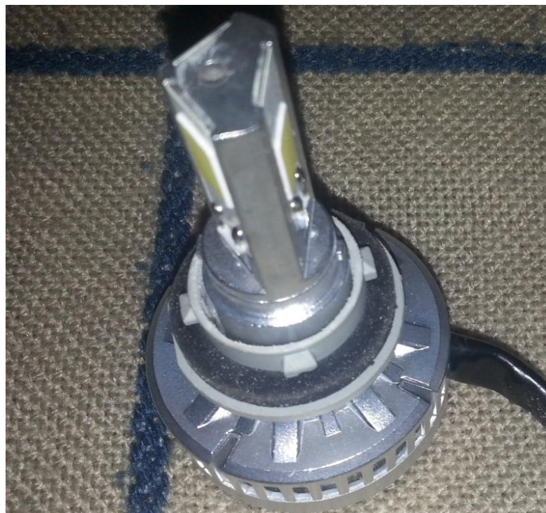
Figura 74. Bombilla led adaptada en el socket modificado.
