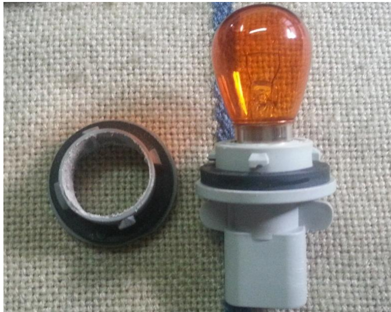
Figura 73. Socket de luz de dirección modificado.
