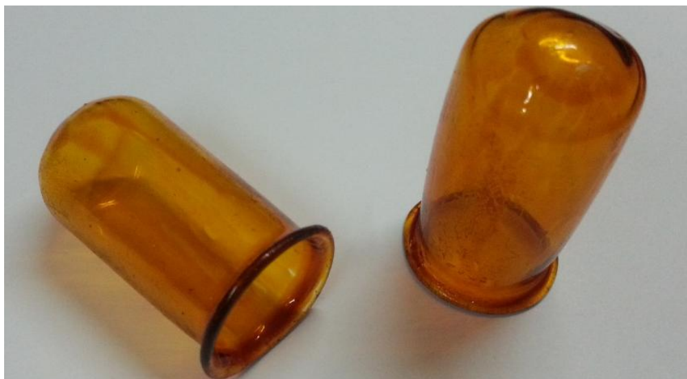
Figura 76. Tinturado de cápsulas de vidrio soplado.
