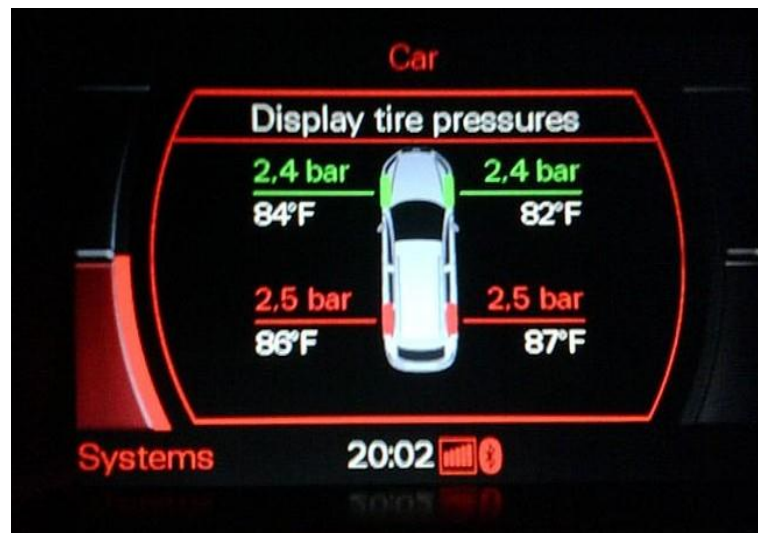
Figura 9. TPMS informa al conductor la presión de los neumáticos (Josep Camós, 2012)
