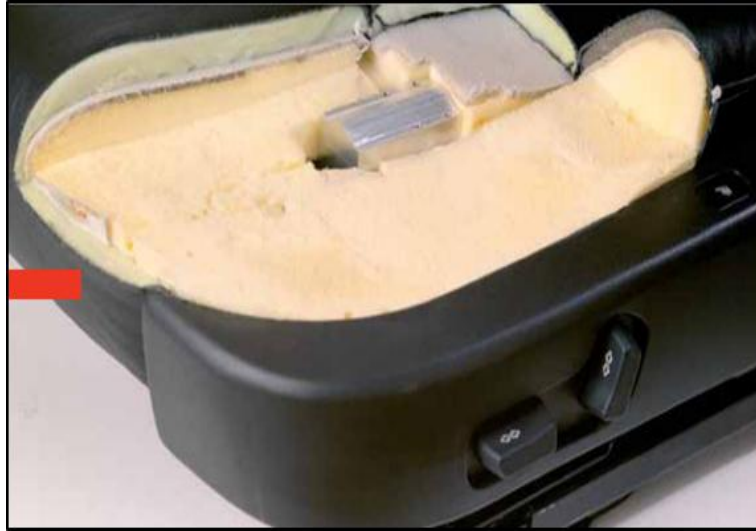
Figura 10. Actuador de alerta por vibración en el asiento del conductor (Óscar Cisneros, 2008)
