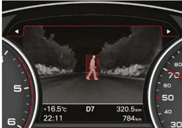
Figura 7. Sistema de visión nocturna con cámara termográfica, pantalla ubicada en el tablero de instrumentos
