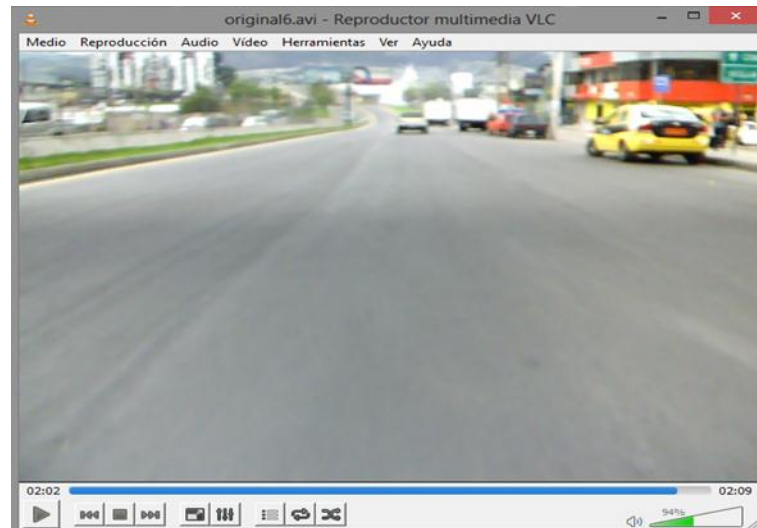
Figura 15. Marcas viales inexistentes, el sistema no puede detectar las líneas delimitadoras de carril
