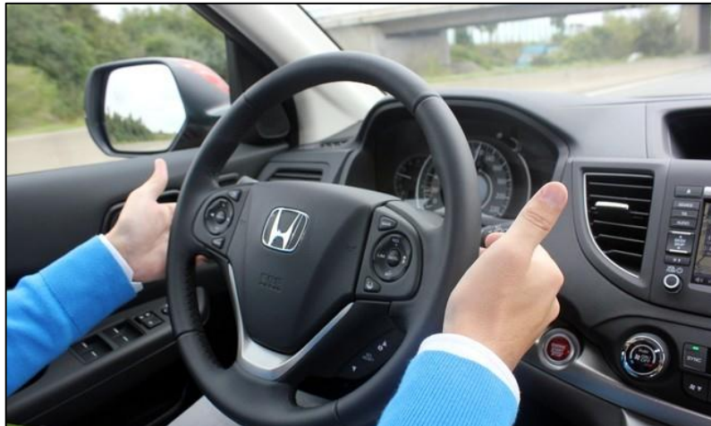
Figura 19. Sistema LKS, alerta de vibración al volante cuando el conductor retira las manos
