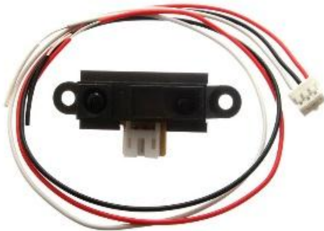
Figura 23. Sensor de proximidad Sharp tecnología infrarroja (Oomlout, 2009)
