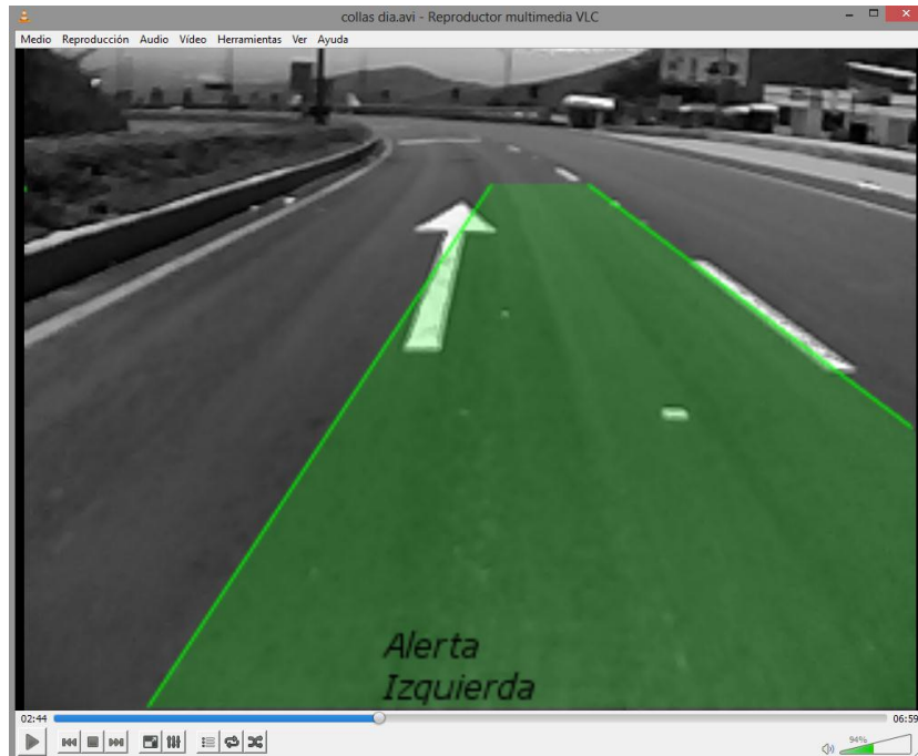
Figura 75. Alerta activada por marca en la vía, en este caso una flecha
