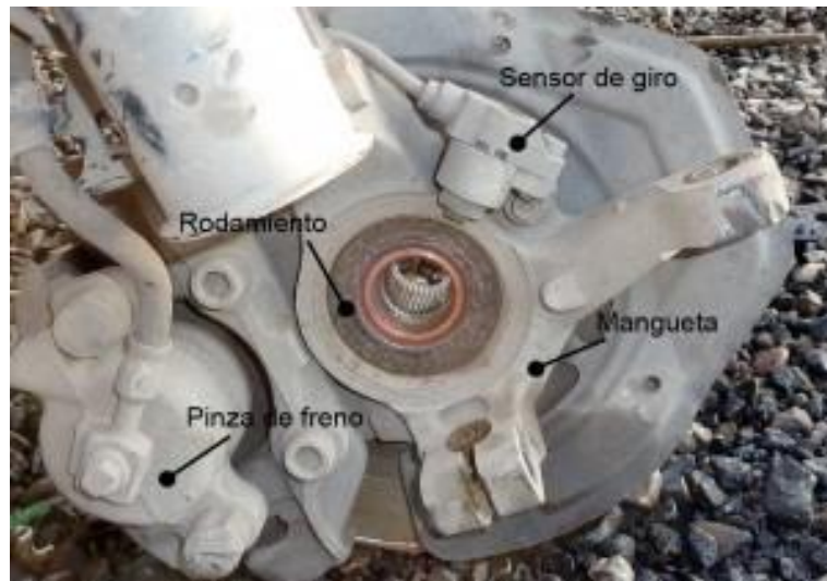
Figura 3. Sistema antibloqueo de ruedas, principal componente el sensor de giro que informa al módulo del ABS sobre las revoluciones de la rueda.
