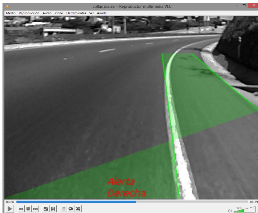
Figura 77. El vehículo sale de la vía de circulación y se dirige hacia la cuneta, el sistema se mantiene en alerta hasta que el conductor regrese al carril de circulación
