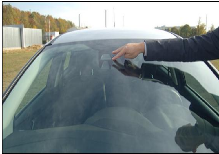
Figura 11. Cámara colocada debajo del retrovisor central del sistema LDW (Josep Camós, 2013)
