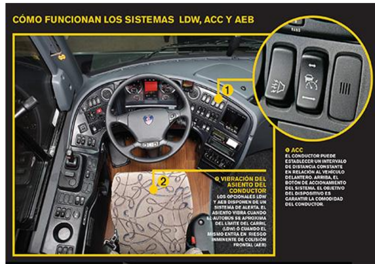
Figura 17. Sistemas de seguridad implementados en autobús Scania, con controles de activación para el conductor
