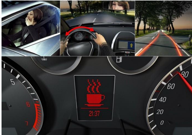
Figura 5. Sistema de alerta anti-sueño, alerta en el tablero de instrumentos
