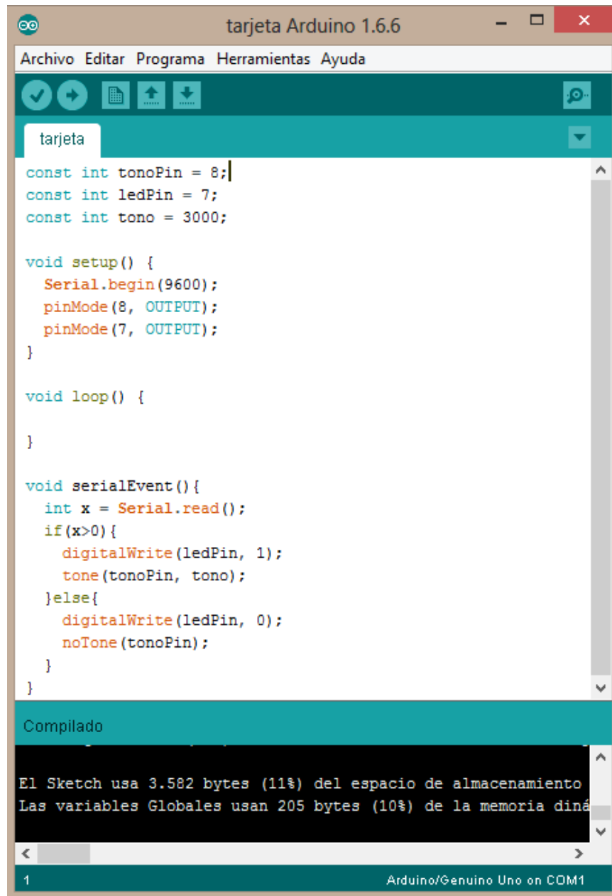
Figura 69. Software de Arduino, Ventana del programa del actuador de alerta acústica y visual de cambio involuntario de carril
