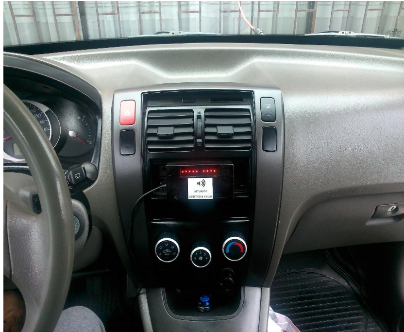
Figura 84. Actuador acústico y visual ubicado en el mando del sistema de audio
