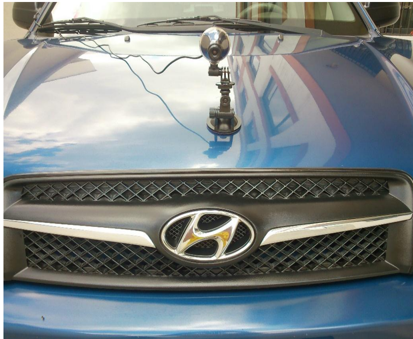
Figura 83. Cámara web ubicada sobre del cofre
