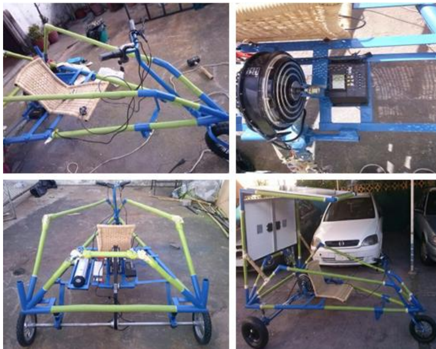
Figura 76 .Montaje de los elementos a la estructura
