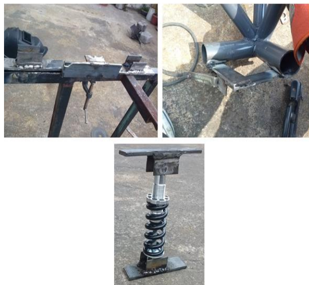
Figura 67. Construcción de bases para amortiguador
