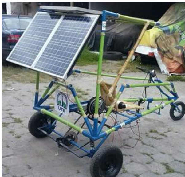
Figura 84. Inclinación de los paneles solares y prototipo terminado
