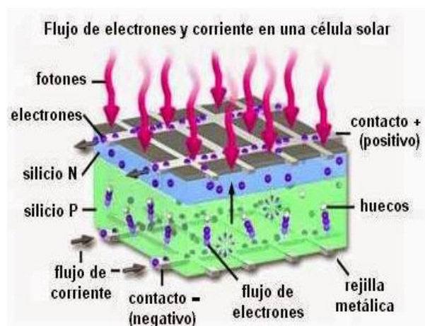
Figura 25. Como se genera la energía en la celda fotovoltaica. (Yuba, 2015)
