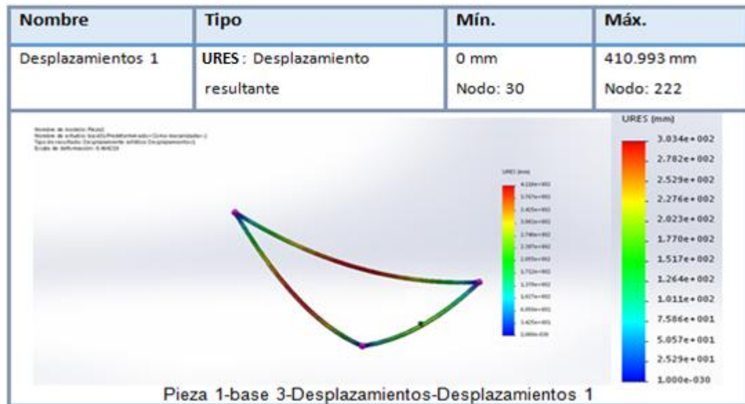
Figura 46. Base de estructura
