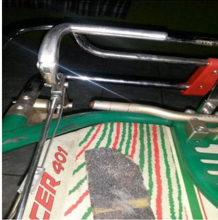
**Figura 34.** Pedal del sistema de frenos.
