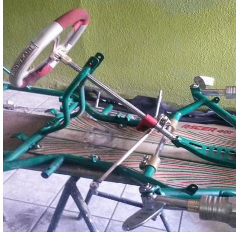
**Figura 27.** Sistema de dirección OTK
