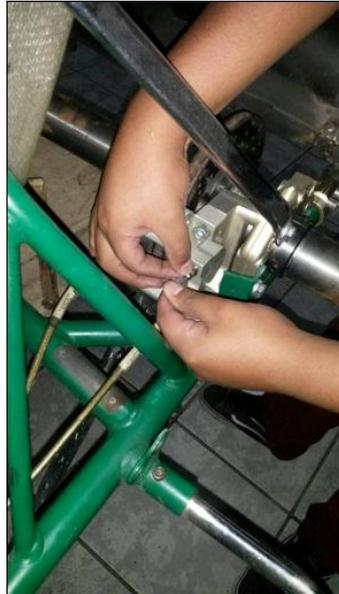
**Figura 41.** Purga del sistema de frenos
