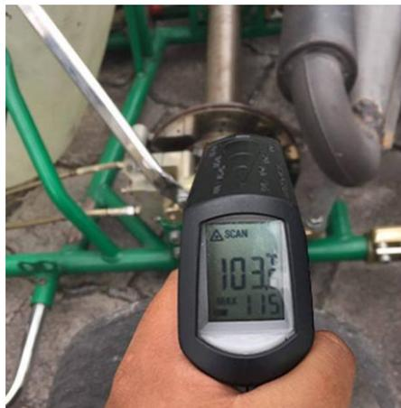
**Figura 49.** Temperatura de discos después de competir (100°C)
