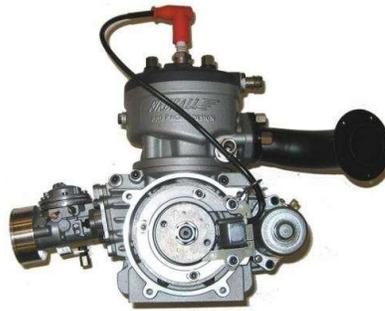
**Figura 4.** Motor de combustión interna usado en karting
