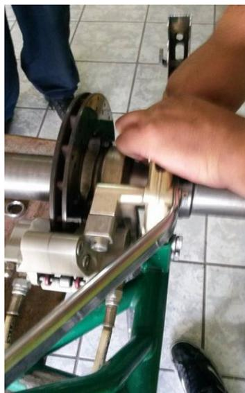
**Figura 39.** Reglaje disco de frenos
