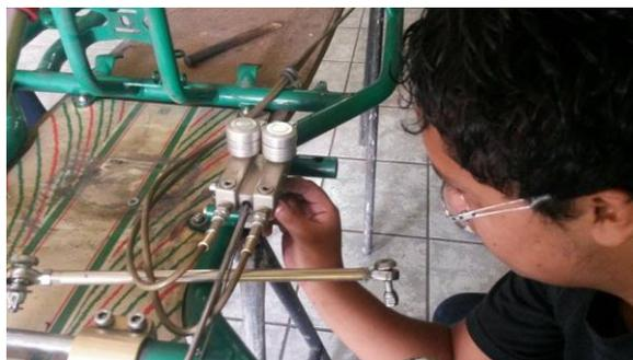
**Figura 33.** Cilindro del sistema de frenos.
