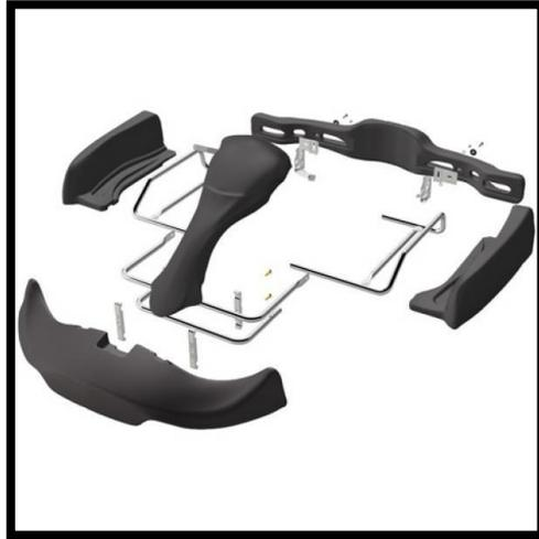
**Figura 9.** Bumpers delanteros, posteriores y protecciones laterales
