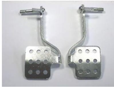
**Figura 22.** Pedales de Acelerador y Freno
