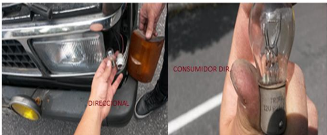
Figura 33. Desmontaje e investigación del direccional derecho delantero
