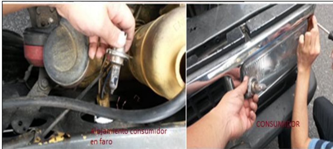
Figura 31. Desmontaje e investigación del faro derecho delantero
