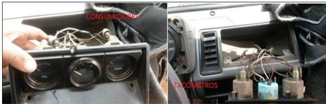
Figura 39. Desmontaje e investigación de los tacómetros adicionales en el vehículo
