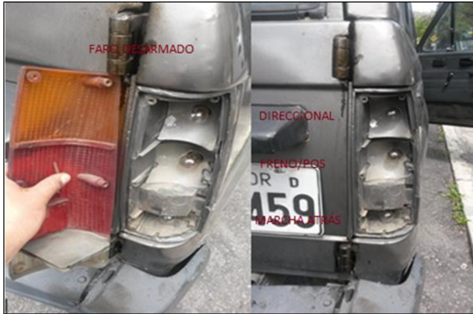
Figura 36. Desmontaje e investigación del faro derecho posterior
