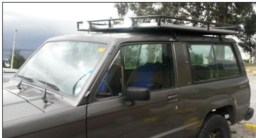
Figura 56. Estructura tipo parrilla instalada en el techo del Chevrolet Trooper
