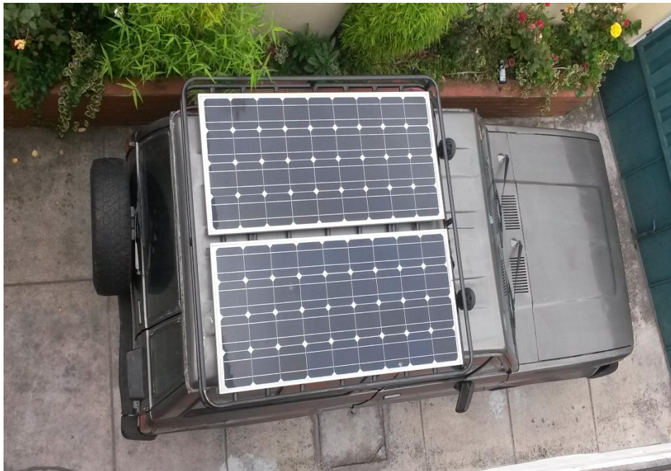
Figura 49. Parrilla estructural de alojamiento para los paneles solares fotovoltaicos en el Chevrolet Trooper.
