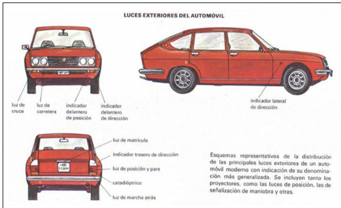
Figura 19. Disposición del alumbrado en un vehículo.
