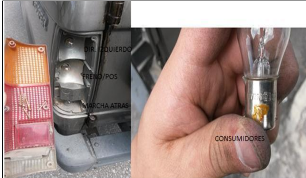
Figura 35. Desmontaje e investigación del faro izquierdo posterior
