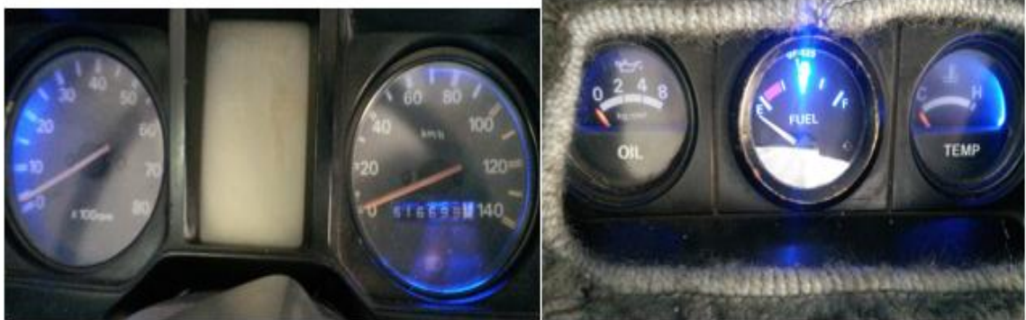
Figura 53. Ubicación de tiras led para la iluminación del instrumental del Chevrolet Trooper.
