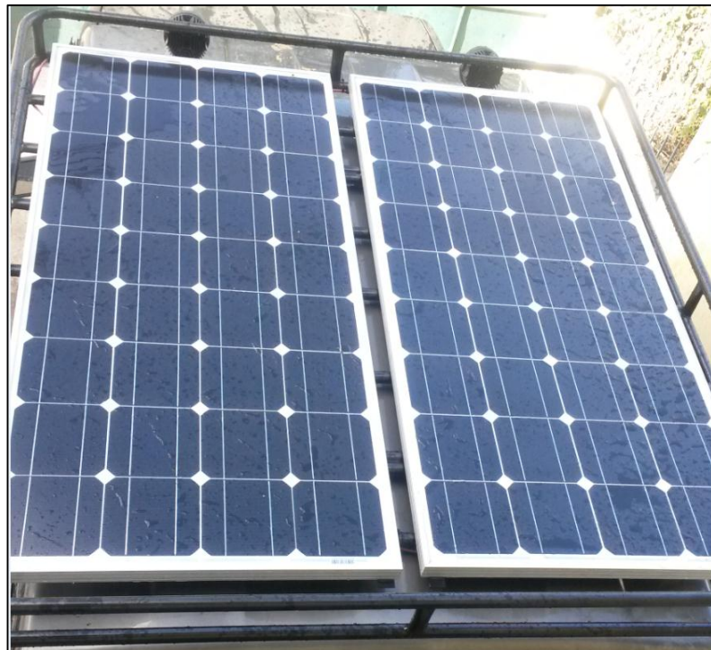
Figura 68. Condiciones de los paneles solares en la segunda prueba, con lluvia y suciedad moderada.
