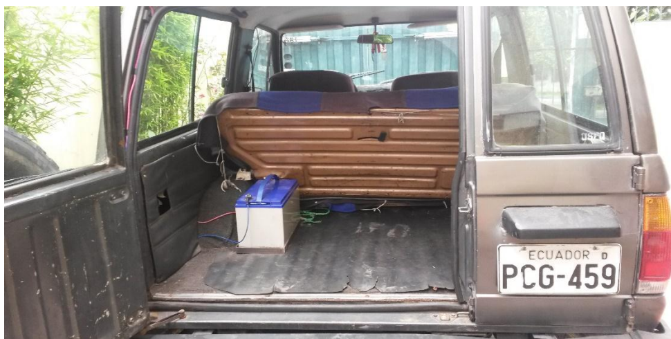
Figura 51. Ubicación de la batería Ultracell del sistema fotovoltaico en la cajuela del Chevrolet Trooper.
