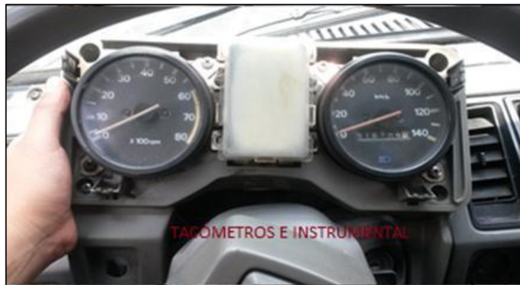
Figura 37. Desmontaje e investigación de los tacómetros principales.
