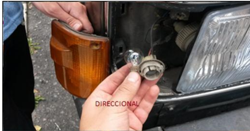
Figura 32. Desmontaje e investigación del direccional izquierdo delantero
