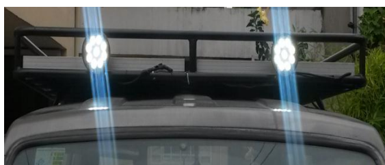
Figura 52. Ubicación de neblineros tipo led en la estructura del techo del Chevrolet Trooper.
