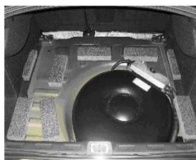
Figura 11. Depósito de GLP.
