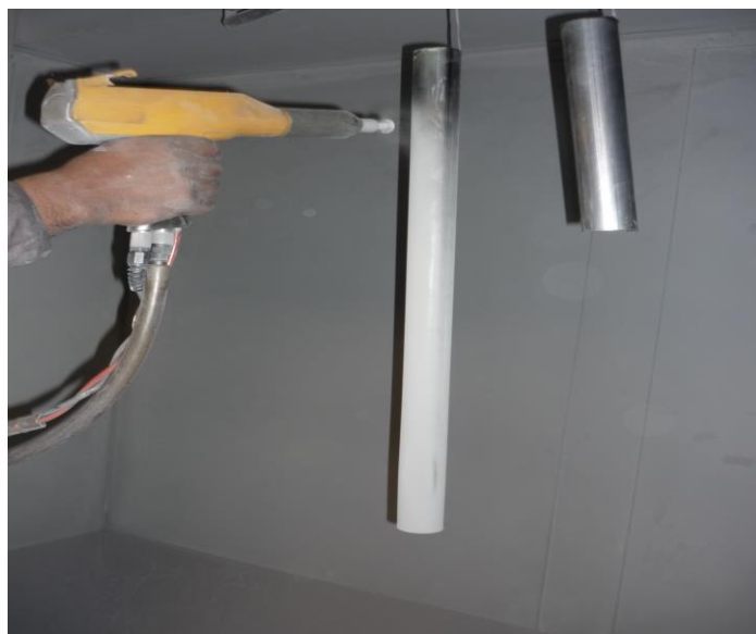
Figura 32. Aplicación de pintura electrostática
