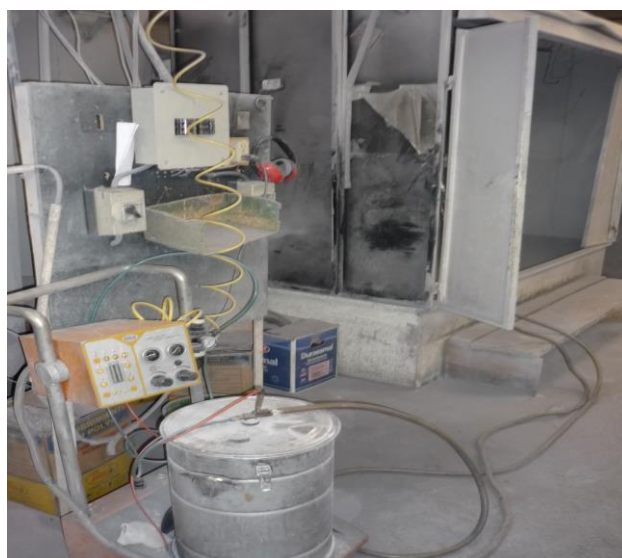
Figura 28. Máquina y equipo para la aplicación de pintura electrostática
