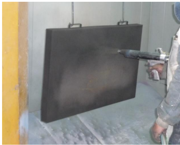
Figura 20. Aplicación de pintura electrostática
