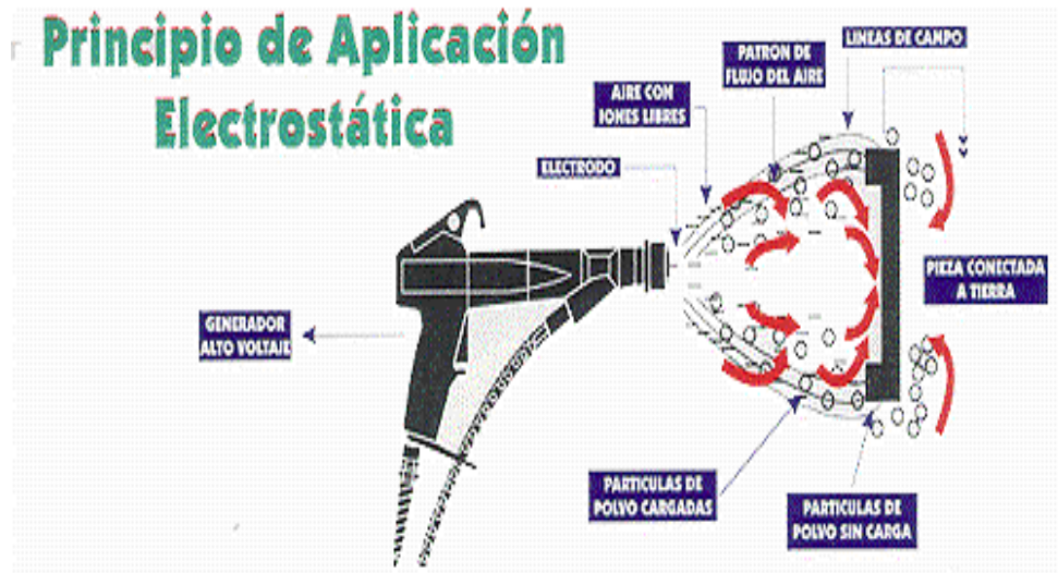
Figura 8. Principio de aplicación electrostática (My Pino, 2010)
