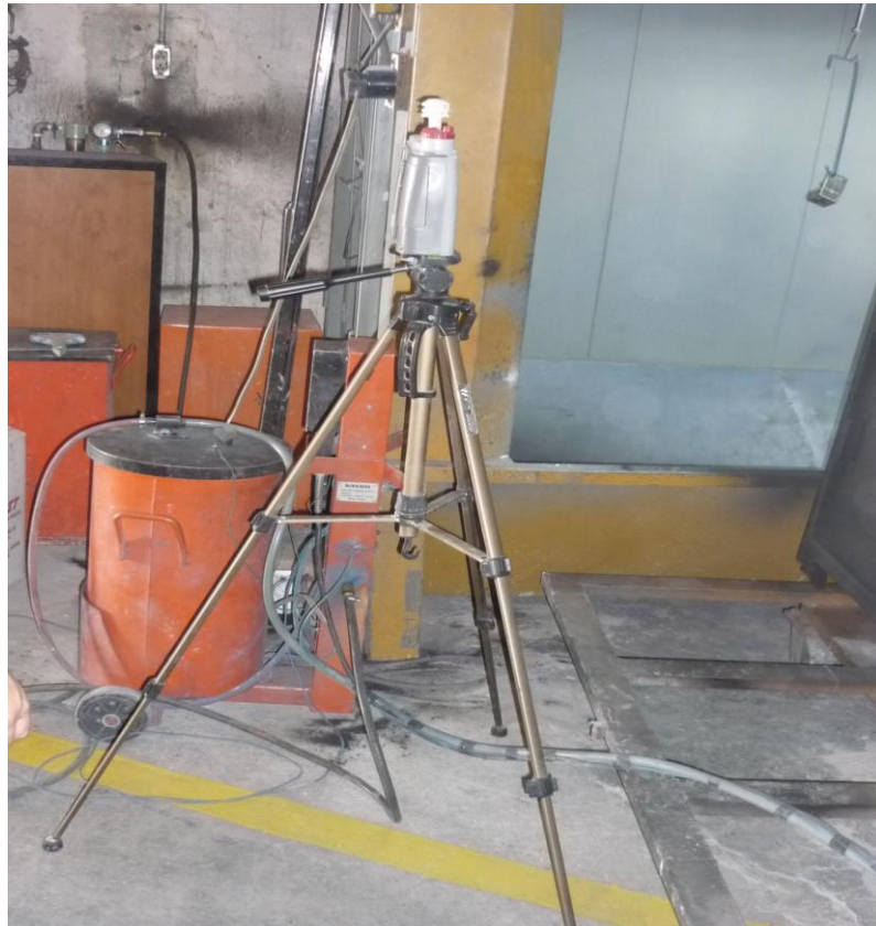
Figura 24. Equipo de medición de material particulado (PM)
