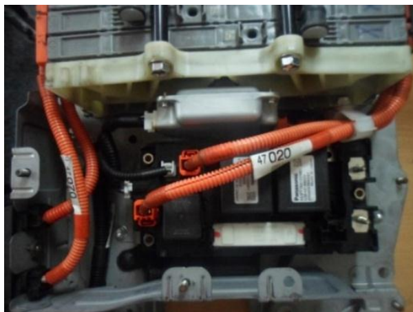
Figura 42. Componentes del módulo ECU de la Batería del Toyota Prius.
