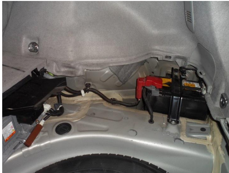
Figura 20. Batería auxiliar desconectada.
