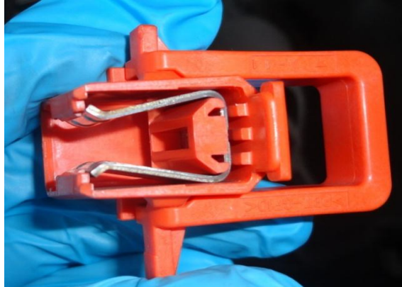
Figura 7. Jumper de seguridad.
