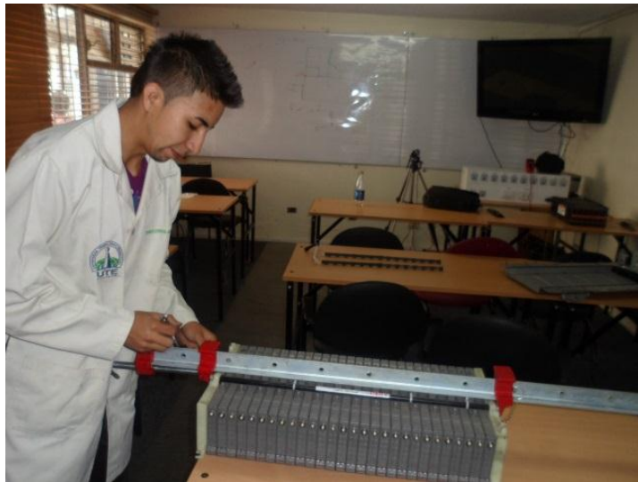
Figura 30. Desmontando bloque de celdas con la prensa.
