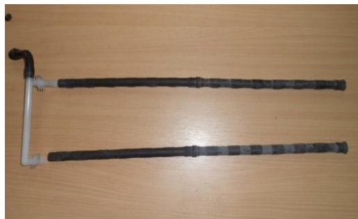
Figura 13. Conductos de enfriamiento.
