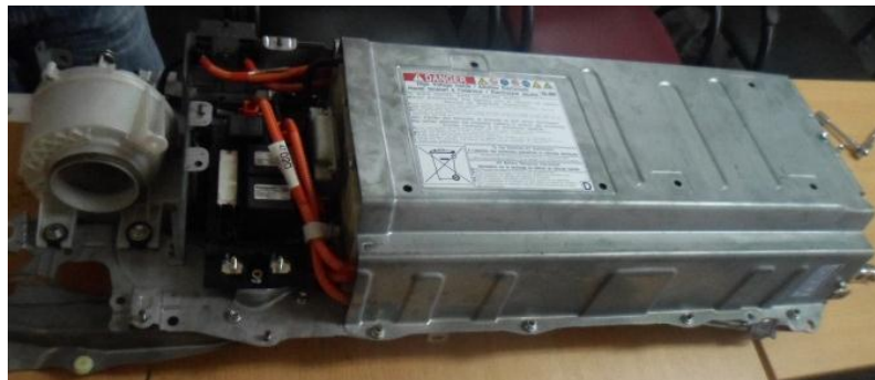
Figura 1. Batería Toyota Prius Híbrido gasolina-eléctrico.
