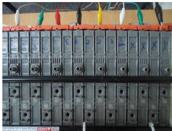
Figura 38. Recarga de la mitad del bloque de celdas.
