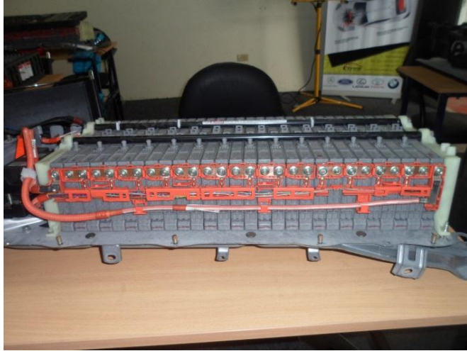
Figura 29. Conectores conectados en serie.
