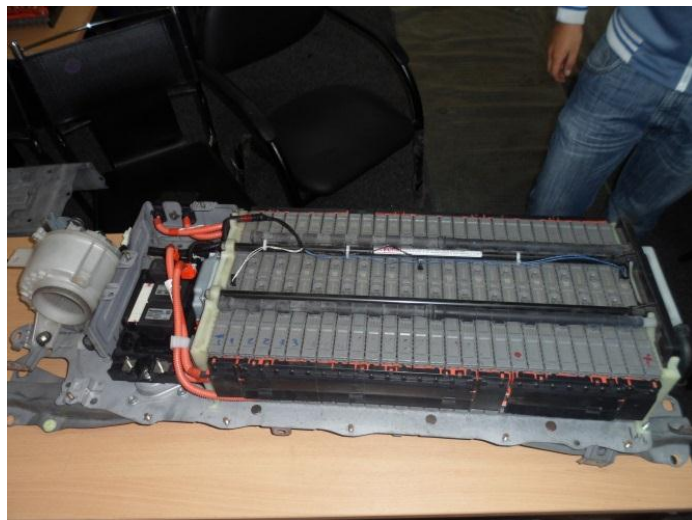
Figura 26. Batería híbrida sin el protector.
