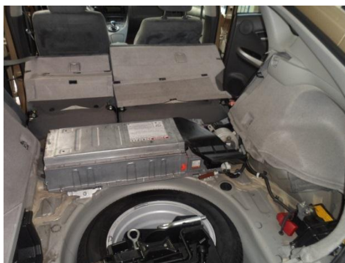
Figura 22. Batería híbrida descubierta en el habitáculo.
