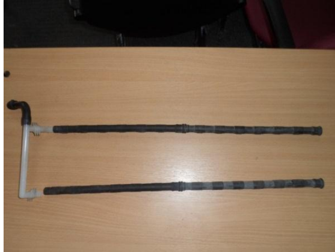
Figura 27. Conductos de ventilación de celdas.
