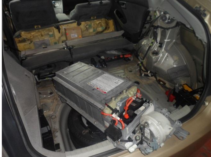
Figura 25. Batería híbrida desmontada de la carrocería.
