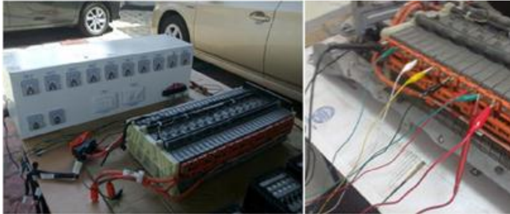
Figura 39. Cargador de baterías del sistema híbrido.
