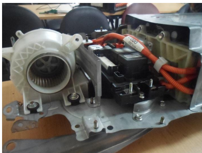
Figura 32. Disposición del ventilador en la carcasa de la batería.
