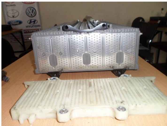
Figura 31. Desmontaje del bloque celdas.
