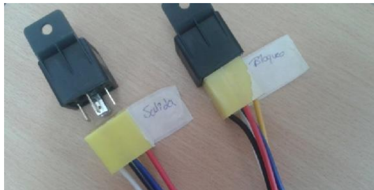
Figura 36. Etiquetado de cables y conexión inicial.
