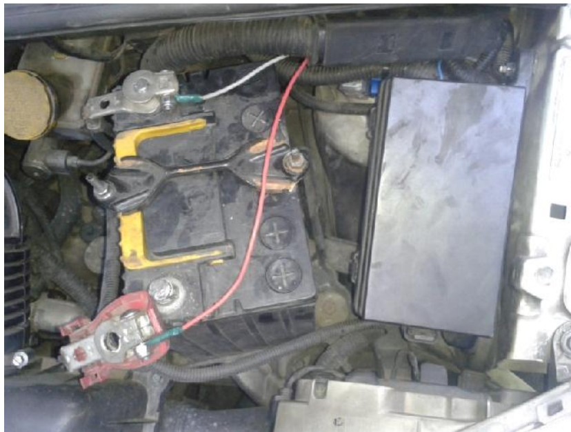
Figura 49. Instalación de Masas y Positivos.
