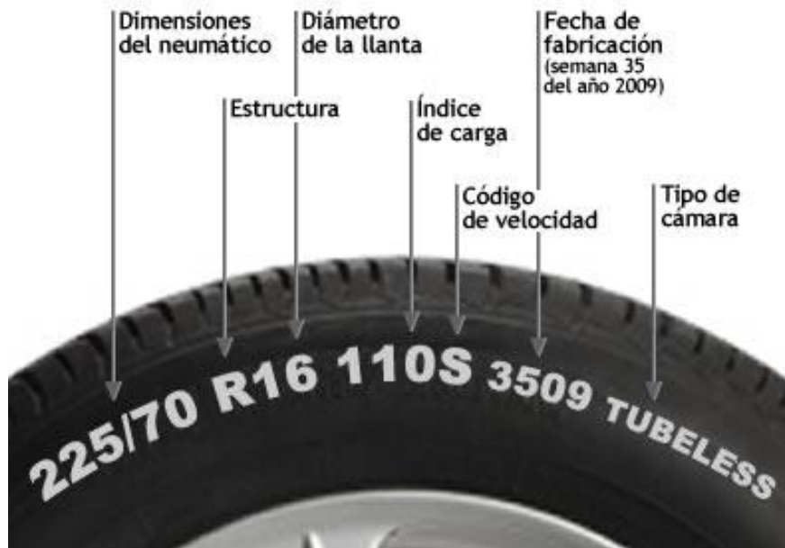
Figura 16. Nomenclatura del neumático. (Todotest)
