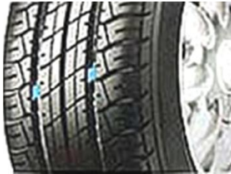
Figura 17. Indicadores de desgaste. (Todotest)
