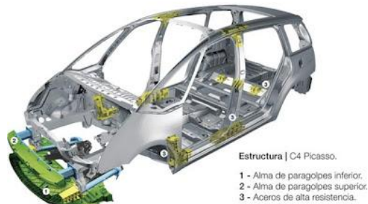
Figura 11. Carrocería Auto-portante (Constanzo, 2012)
