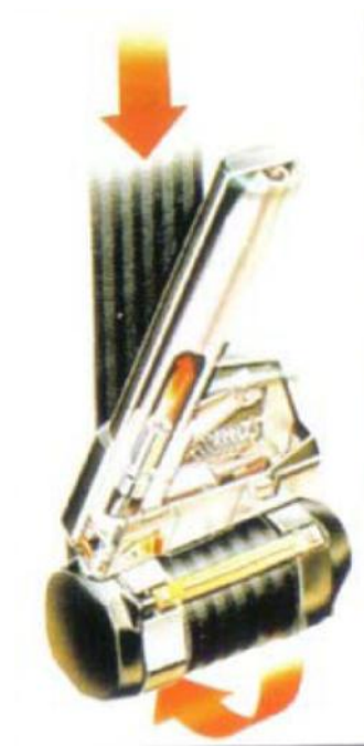
Figura 5. Tensor pirotécnico (Guerrero, 2008)
