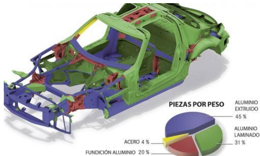
Figura 12. Porcentajes de los materiales en una carrocería (Instituto de Investigación sobre reparación de vehículos, 2013)
