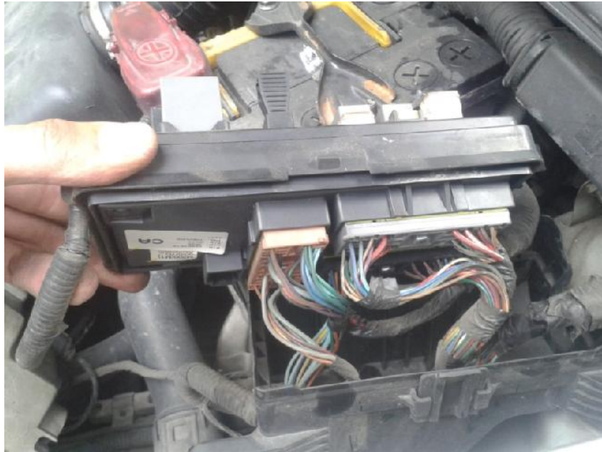
Figura 46. Desconexión de caja de fusibles.
