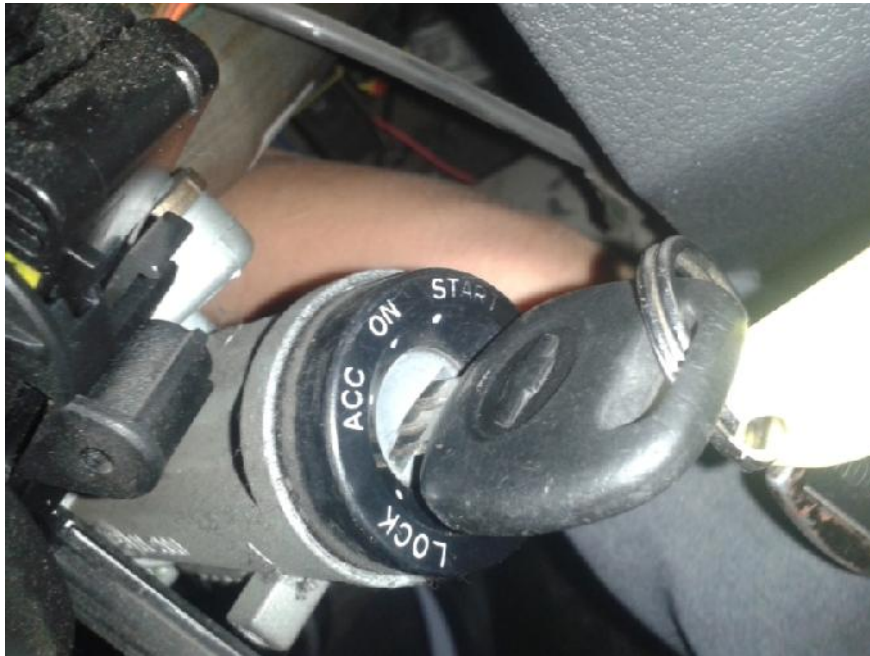
Figura 50. Pruebas de encendido y de posición final.
