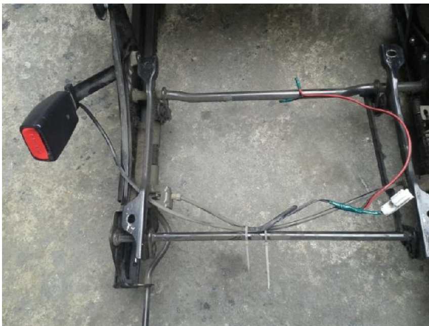
Figura 43. Instalación de cableado de asientos.
