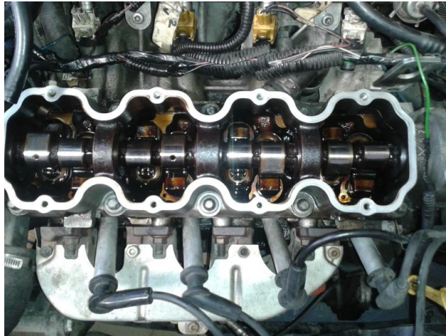
Figura 47. Calibración de Válvulas
