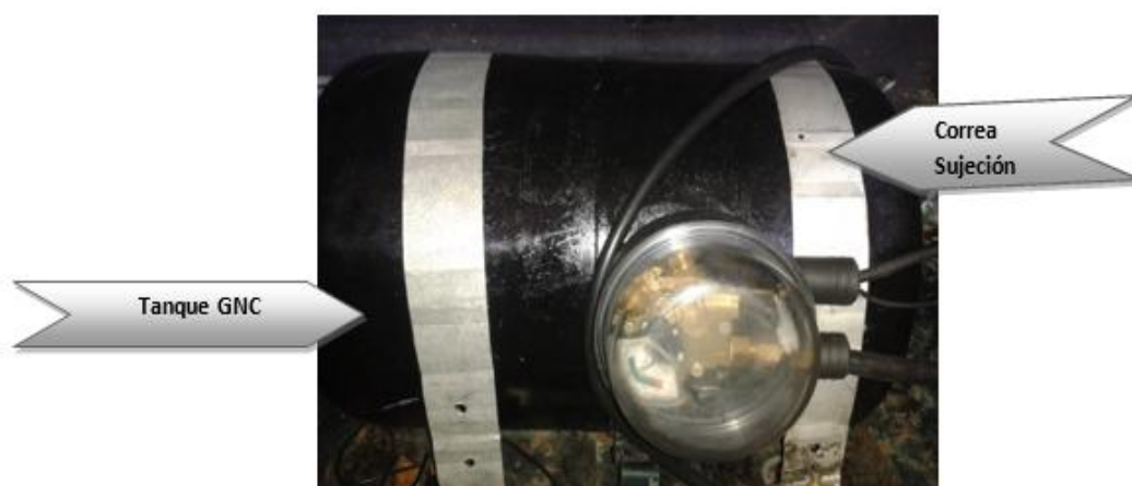
Figura 54. Adaptación y sujeción del Tanque de G.N.C.
