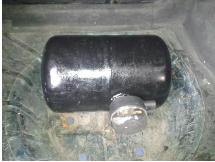
Figura 30. Tanque estacionario colocado en el baúl
