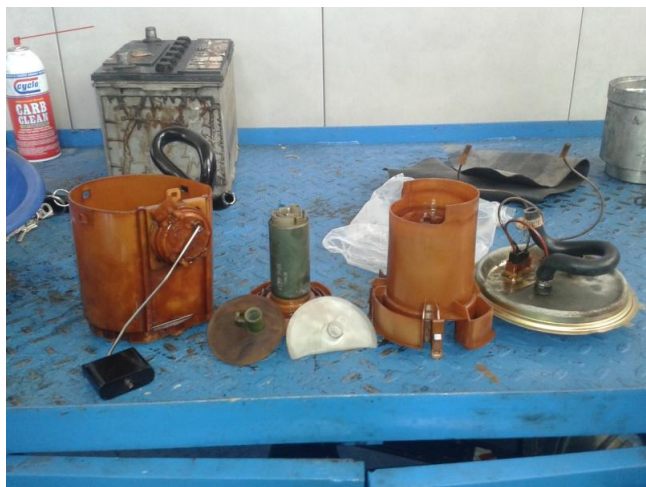
Figura 49. Sustitución de Filtros y Bomba de Combustible
