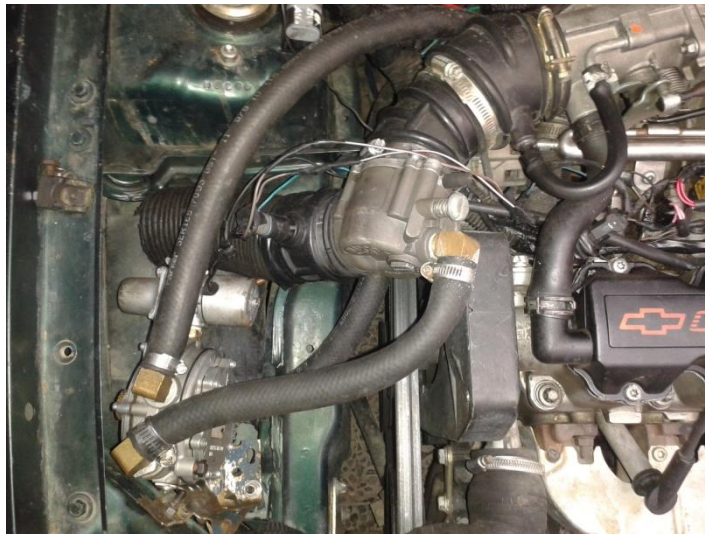
Figura 41. Mangueras Sistema de Refrigeración
