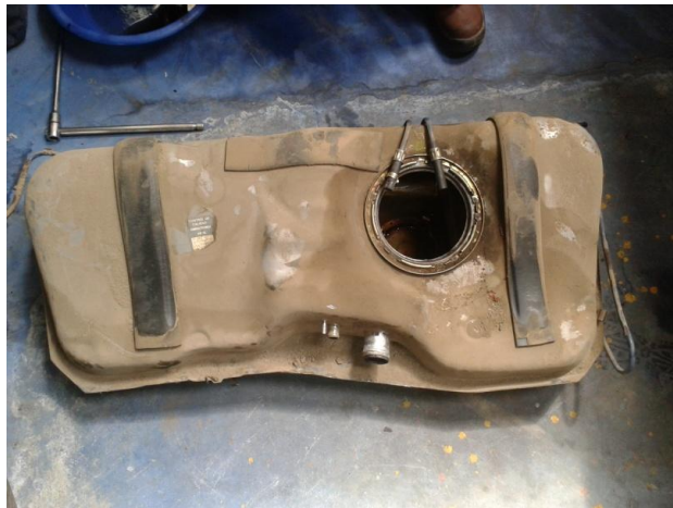
Figura 48. Limpieza del Tanque de Combustible
