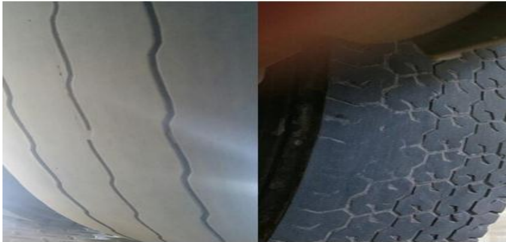
Figura 18. Defecto tipo 3 en llantas (insuficiente labrado)
