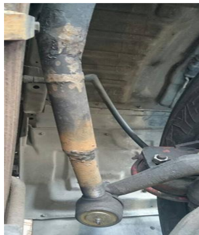
Figura 13. Defecto tipo 3 en brazo de dirección (soldado/modificado)
