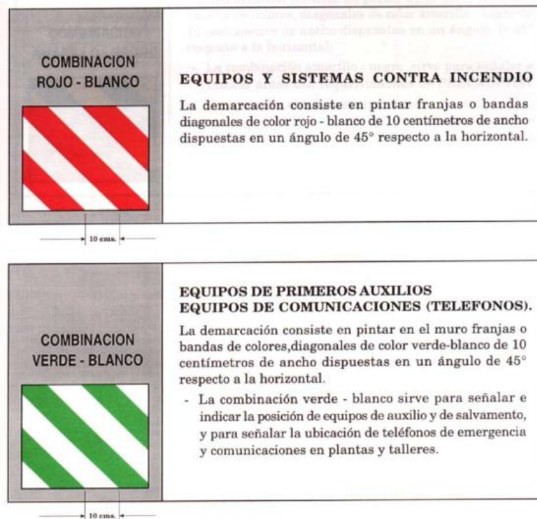
Figura 22. Combinación de líneas, para rotulado en paredes, se puede diferenciar que estas líneas son utilizadas en la normativa nacional (CODELCO, 1997)
