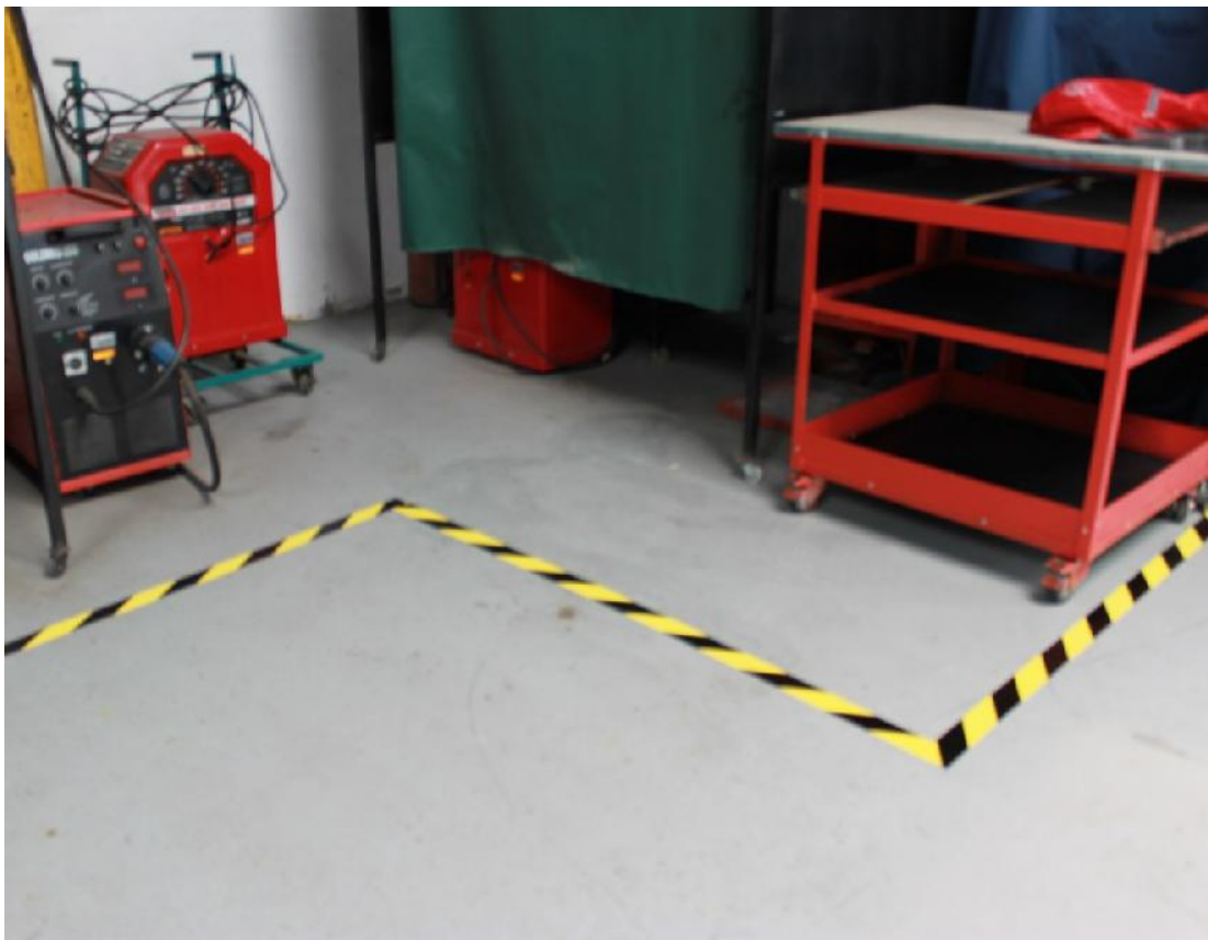
Figura 71. Área de soldadura con rotulación
