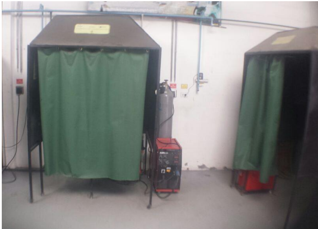
Figura 48. Mala rotulación de áreas de riesgo
