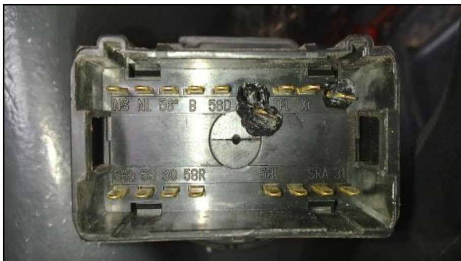
Figura 37. Cerebro de luces principales recalentado (Taller Eléctrico Chávez, 2014)
