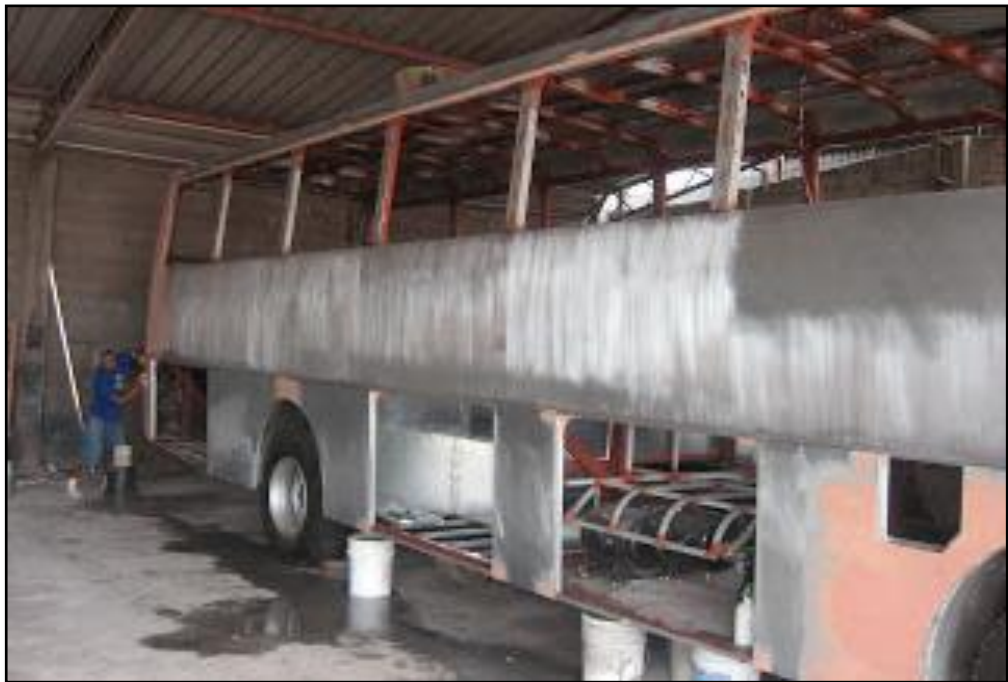
Figura 7. Forrado de la estructura (Construcción de un bus, 2012)
