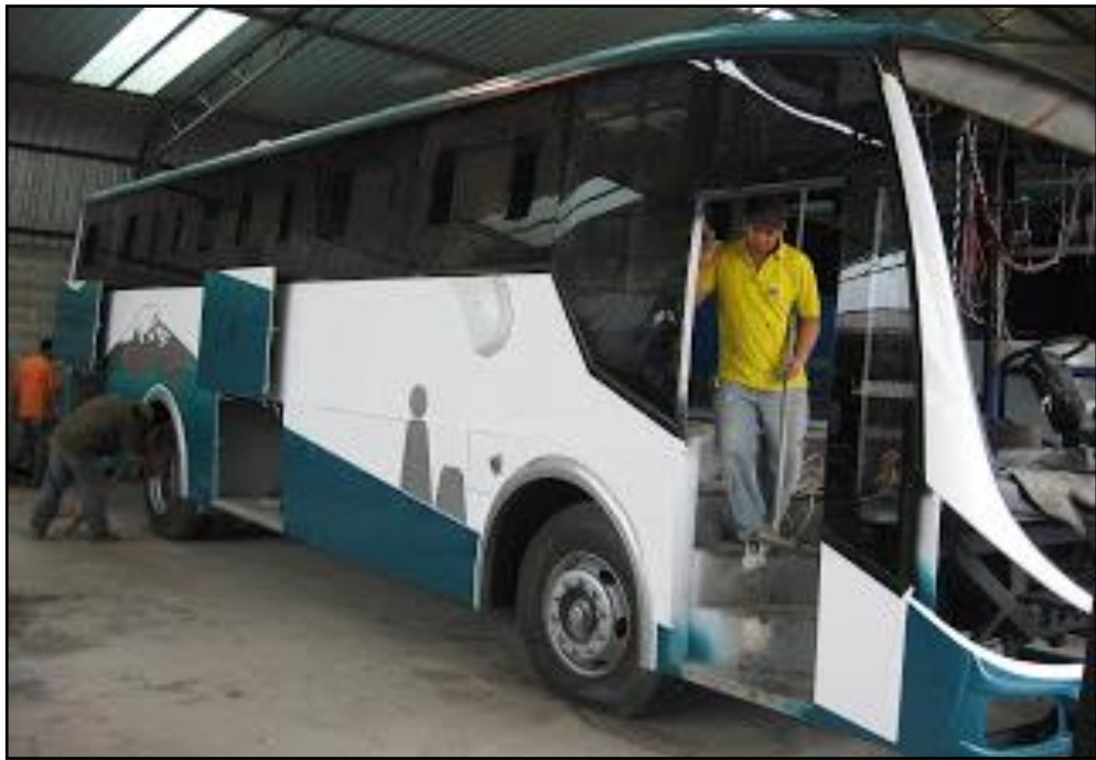
Figura 12. Instalación de acabados
