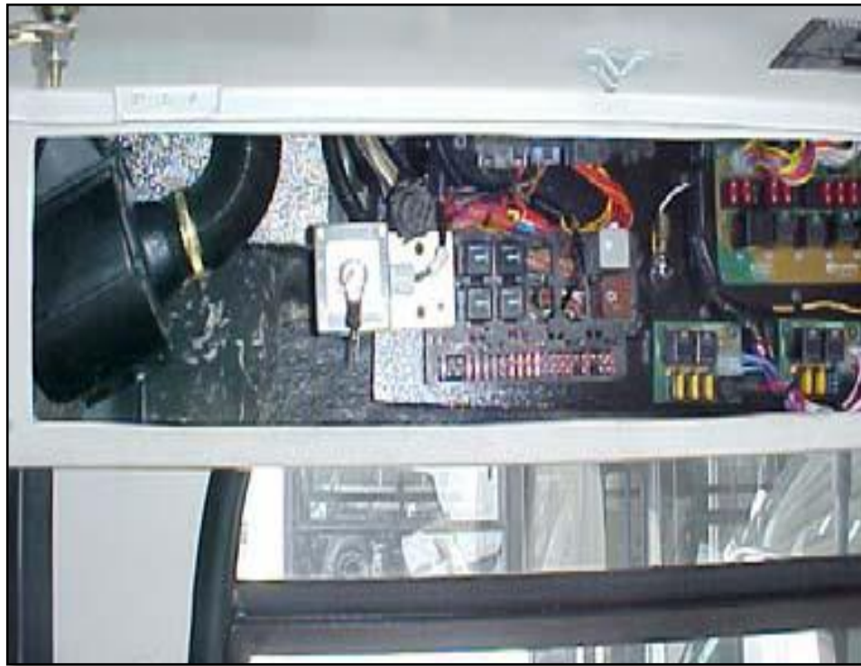
Figura 115. Caja de control ubicada sobre el puesto del chofer (VOLKSWAGEN, Diretrizes_ Espanhol_2008_cap9, 2009)
