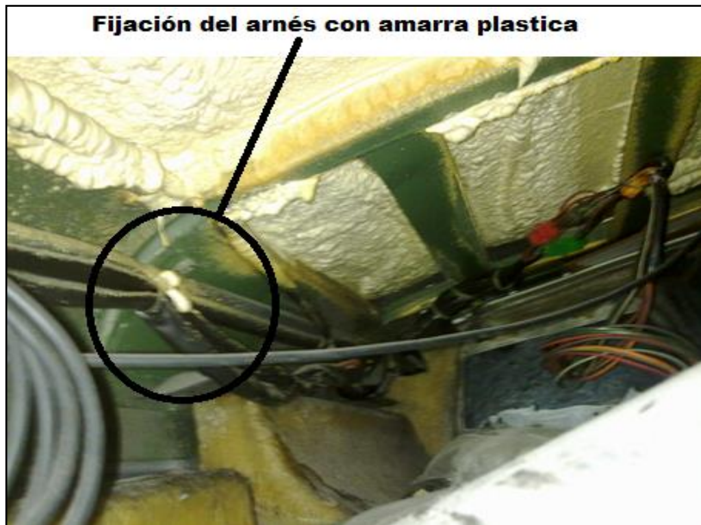
Figura 159. Fijación de arneses, carrocería Busscar Jumbus 360 (Taller Eléctrico Chávez, 2014)
