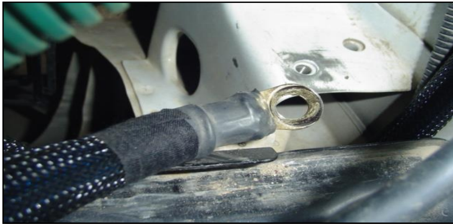
Figura 120. Conjunto de cables de tierra forrados en arnés (EMSSI, 2007)
