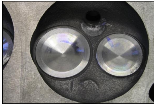
Figura 10. Cámara de combustión.
