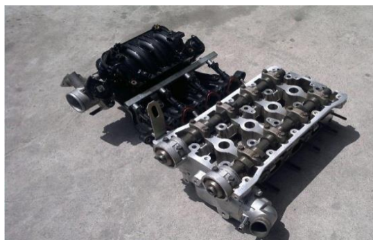
Figura 38. Rehabilitación del mecanismo de válvulas del motor.
