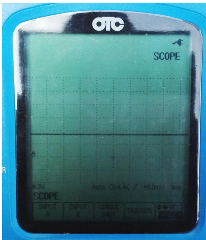
Figura 89. Gráfica de señal sensor de oxígeno 1
