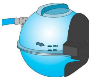
Figura 8. Depósito de expansión
