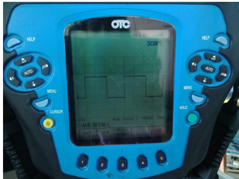
Figura 84. Gráfica terminal positivo TAC
