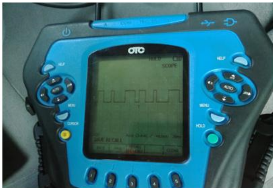
Figura 75. Gráfica de funcionamiento del sensor CMP
