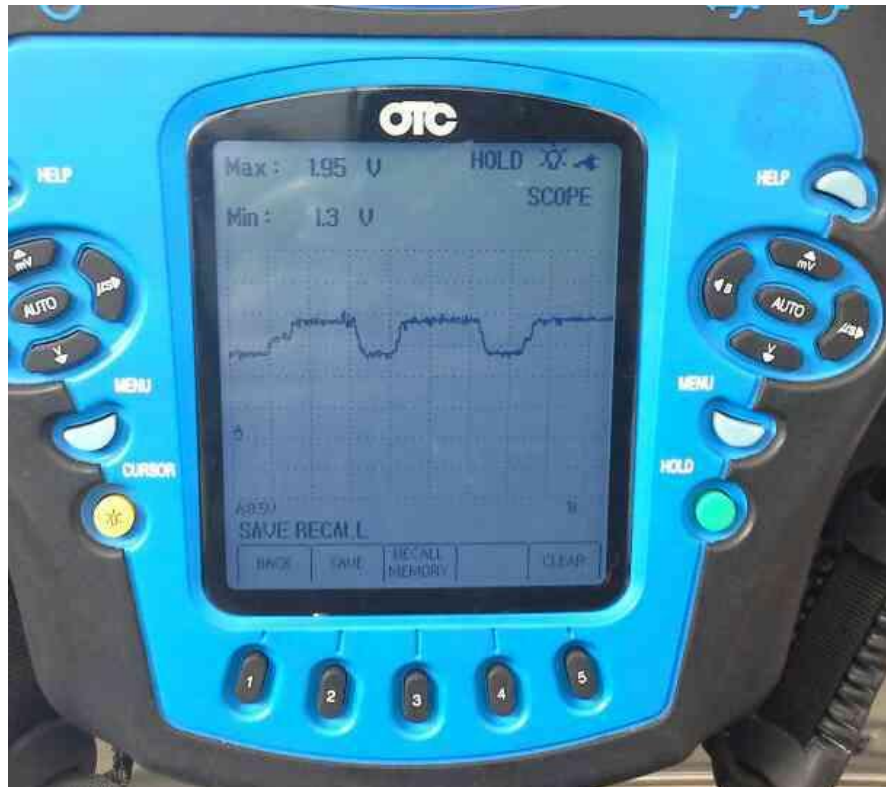
Figura 74. Gráfica de funcionamiento del sensor MAF
