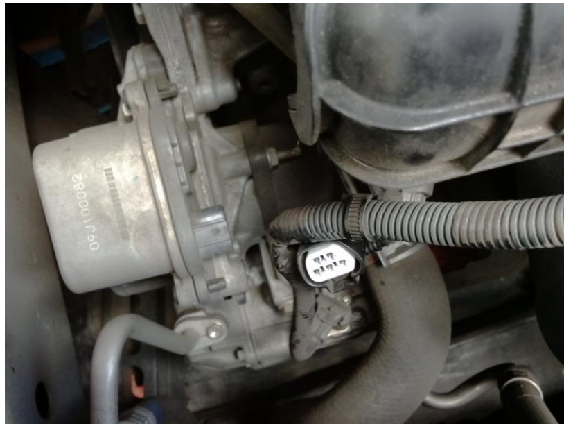
Figura 68. Bomba de agua eléctrica
