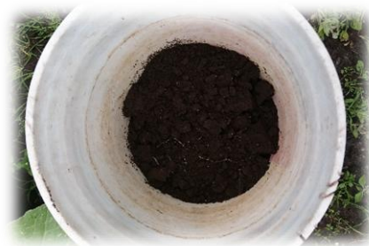
Fotografía 4. Homogenización de las sub-muestras para obtener la muestra principal
