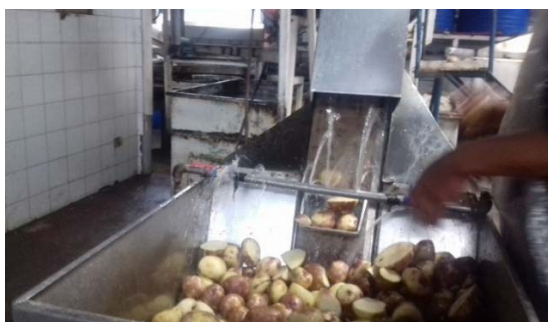
Figura 11. Tolva de alimentación con aspersores de lavado
