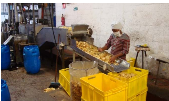
Figura 14. Freidora y subproceso de selección
