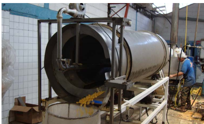
Figura 18. Bombo giratorio de sazonado
