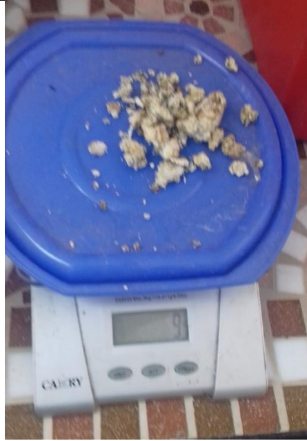
Figura 27. Lodos secos de las aguas residuales de cárnicos sin tratamiento.
