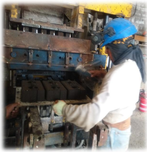
Figura 21. Extracción del prefabricado (Muñoz, 2015)
