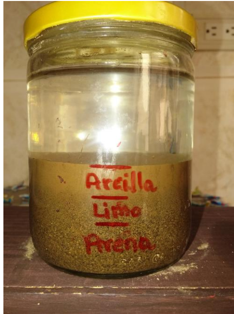
Figura 17. Prueba de determinación de la textura del suelo (Muestra 2) (Muñoz, 2015)
