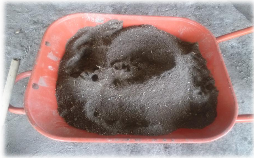
Figura 19. Mezcla de materia prima: suelo, cemento, residuos de maíz y aserrín
