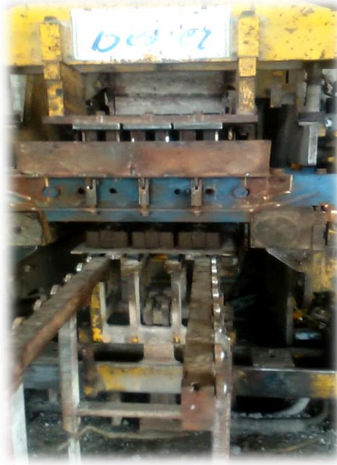
Figura 20. Llenado de moldes y compactación
