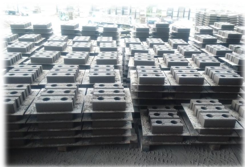
Figura 22. Curado y almacenamiento (Muñoz, 2015)
