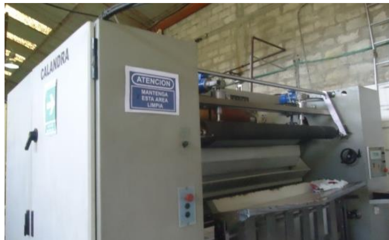
Figura 10. Zona de alimentación del calandro
