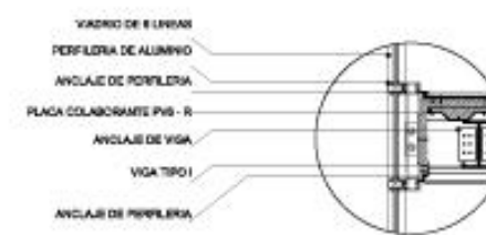
DETALLE DE FACHADA DE VIDRIO ESCALA 1:50
