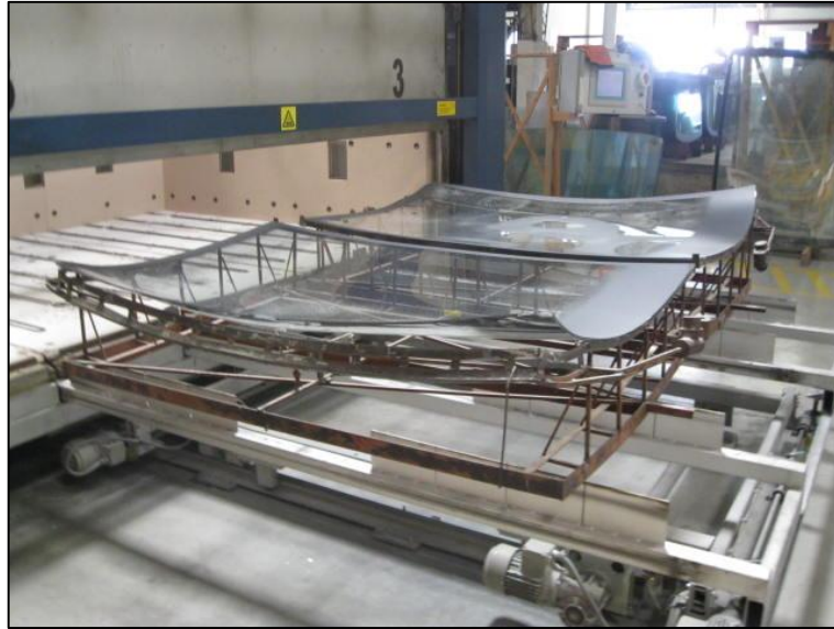
Figura 11: Parabrisas curvados en horno eléctrico
