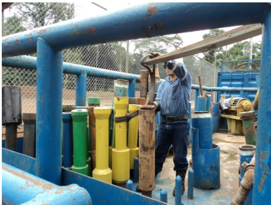
Obrero de patio realiza amarre de lifting sub para levantar con el montacargas
