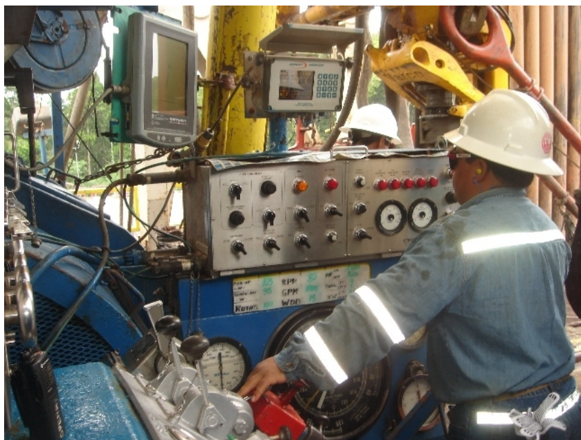
Operación de equipos: consola del perforador
