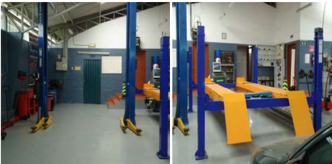
Gráfico 4.1 Carencia de señalización horizontal
