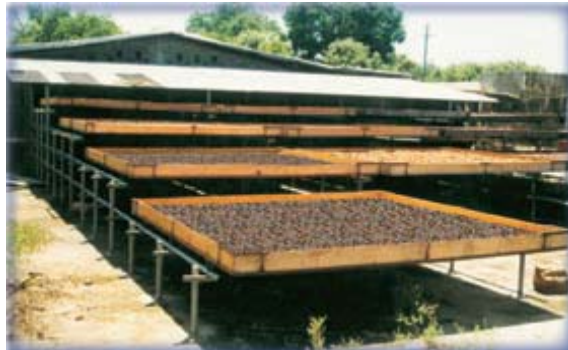
Secador tipo elba, con carros corredizos
