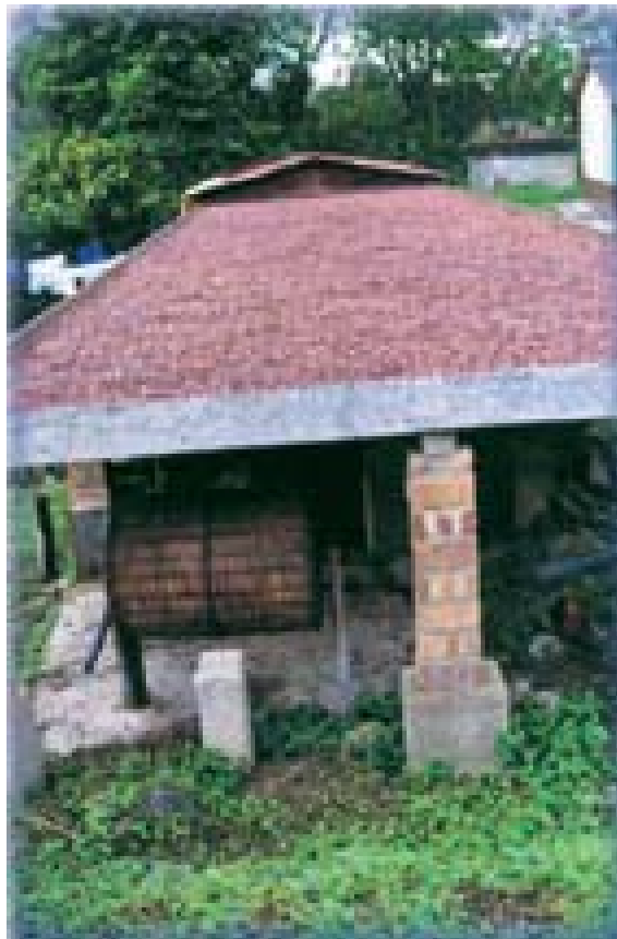
Barril fermentador y secador tipo elba
